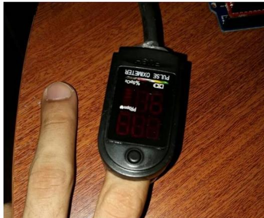
Figura 4.10 Conexión del sensor de pulso y oxígeno en la pcav2.0 (paso 2).
