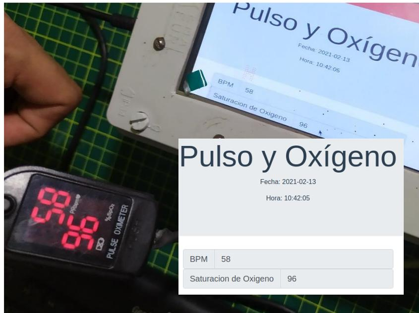
Figura 5.13 Toma de datos del pulsi oxímetro (con captura de Raspberry)
