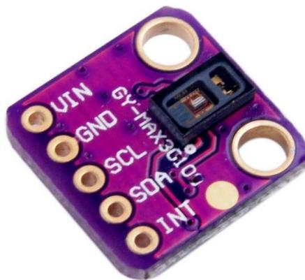
Figura 2.18 Sensor de Oximetría y Pulso Cardíaco
