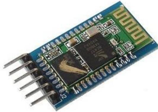
Figura 2.19 Dispositivo Bluetooth para Arduino
