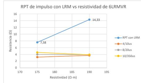
Figura 4.11: RPT de impulso con LRM vs resistividad de 6LRMVR
