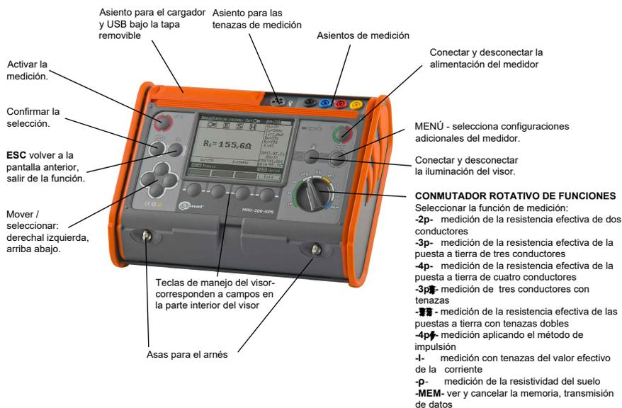
Figura 3.4: Telurómetro digital marca Sonel modelo MRU-200-GPS.
