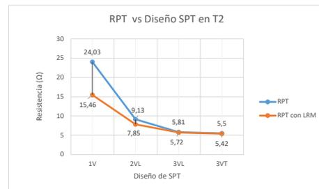
Figura 4.30: RPT vs Diseño SPT en T2
