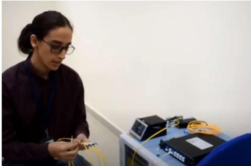
Figura 5.5 Revisión de conexiones del módulo DWDM
