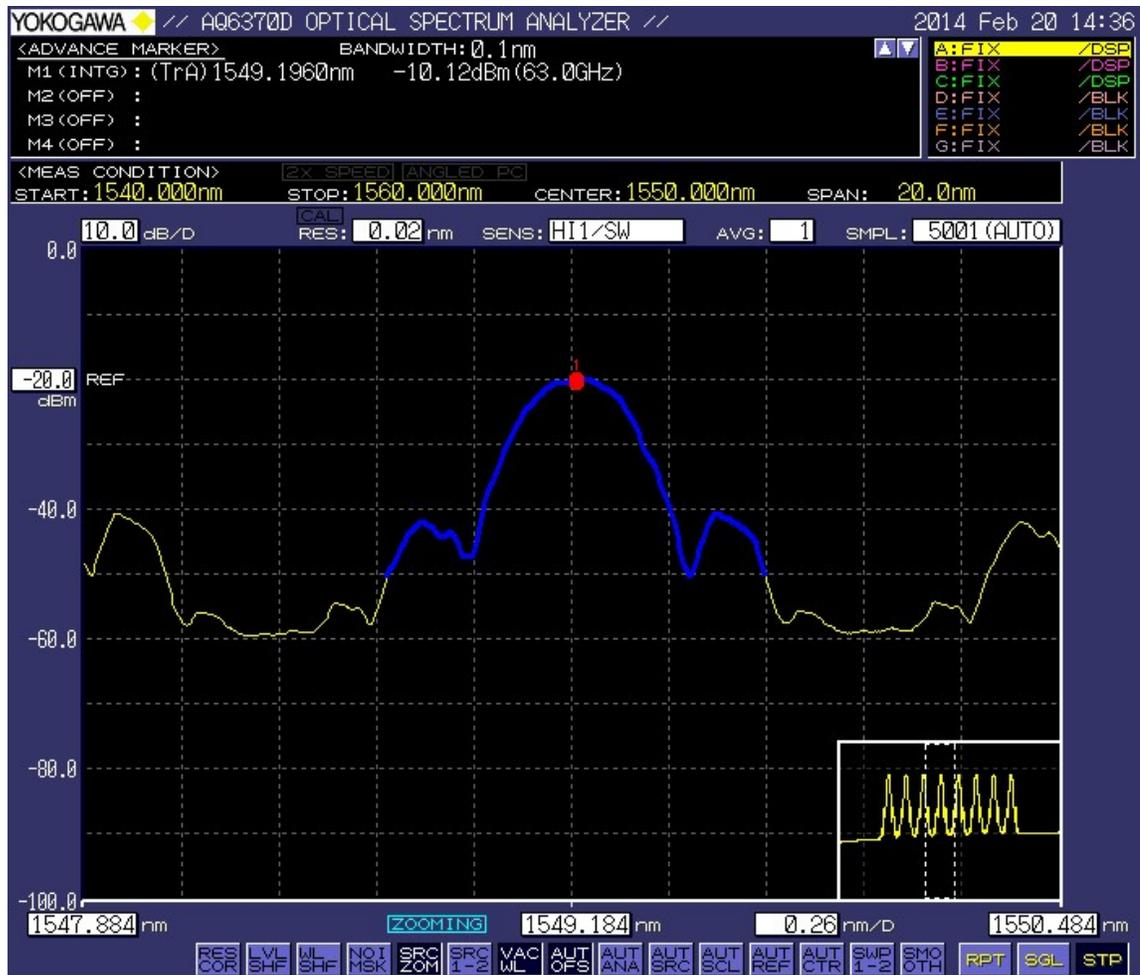
Figura 3.10 Ejemplo del marcador avanzado
