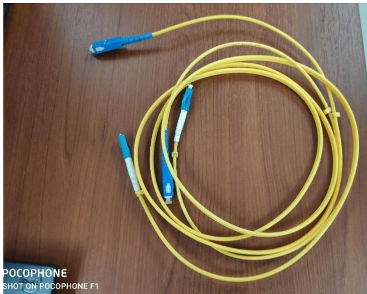
Figura 53. Patchcord de fibra óptica adicional para módulo
