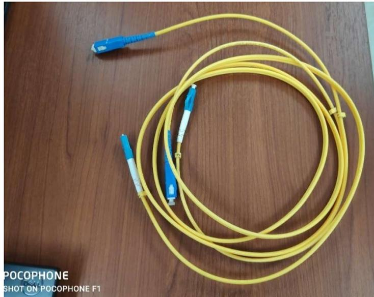
Figura 4.9 Patchcord de fibra óptica adicional para módulo
