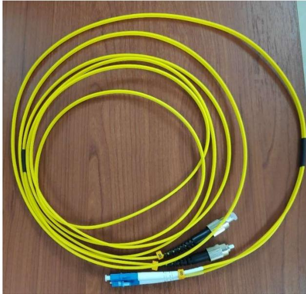
Figura 4.4 Patchcord de fibra óptica
