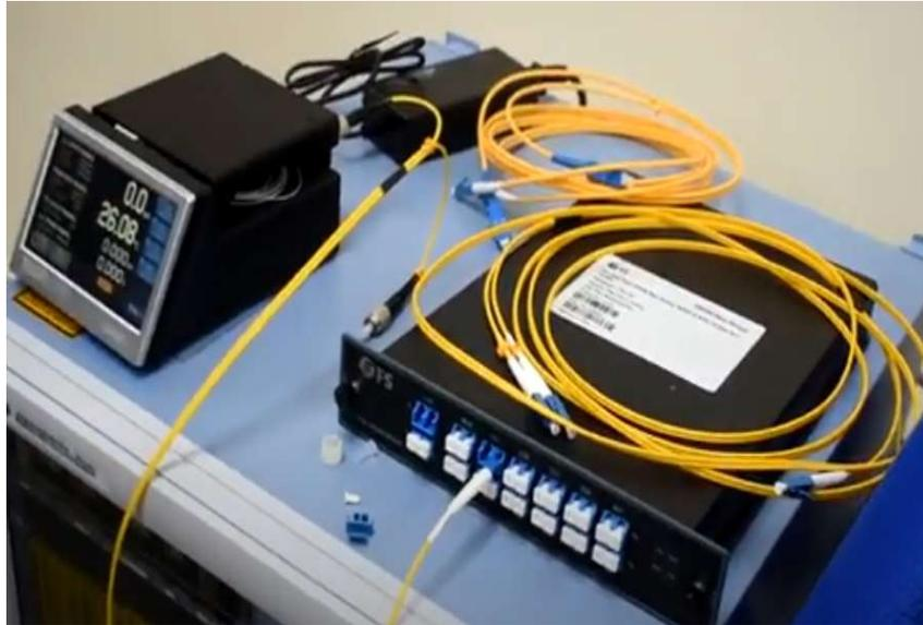
Figura 50. Módulo DWDM conectado
