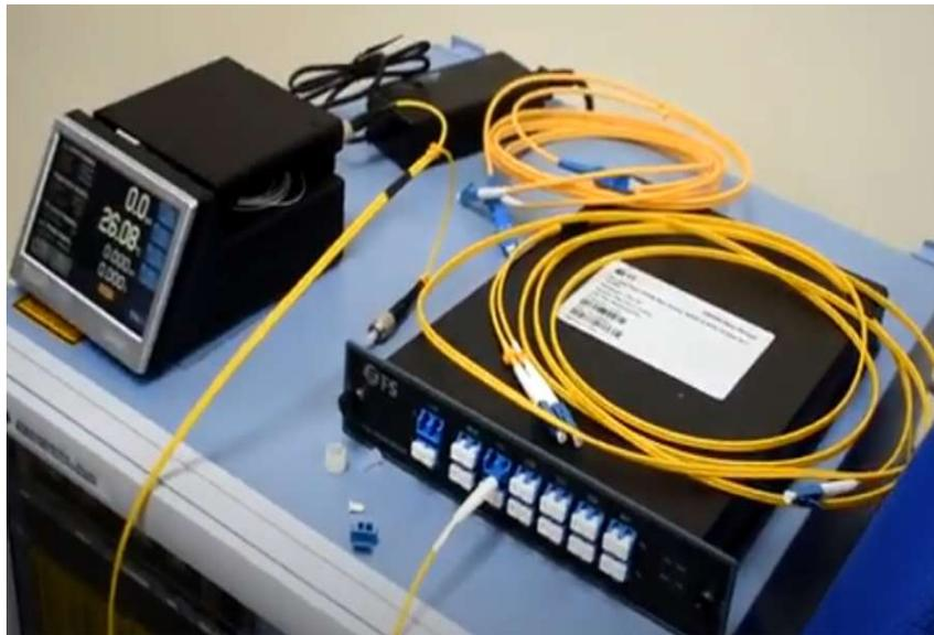
Figura 4.6 Módulo DWDM conectado
