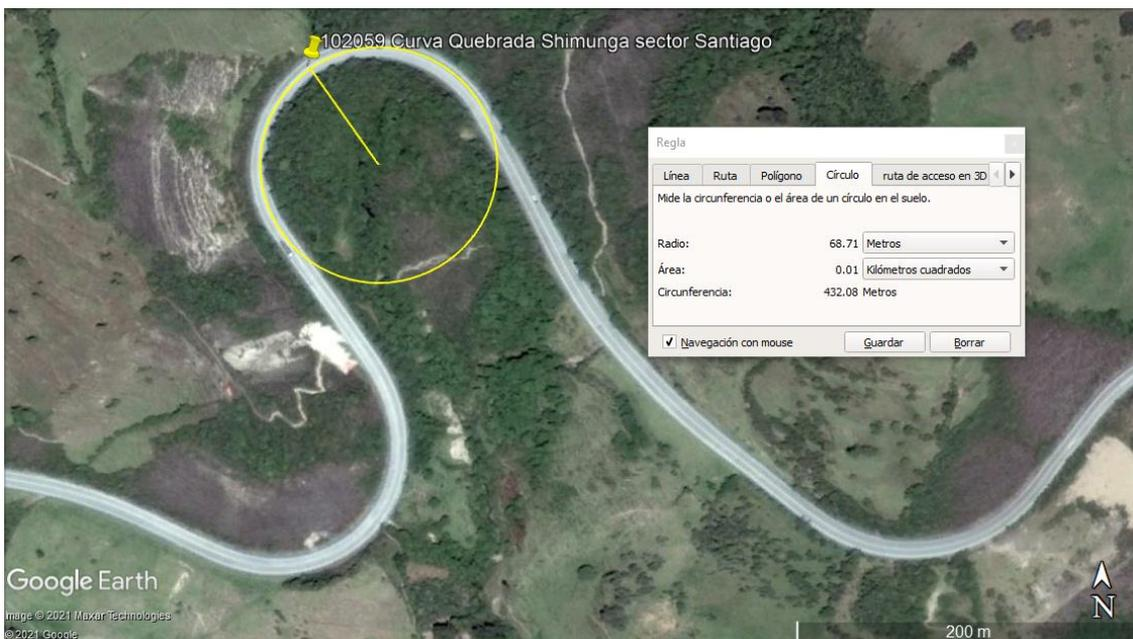
**Figura 40:** Valor del radio de curvatura en la Quebrada Shimunga sector Santiago con Google Earth *Pro*. **Fuente:** (Google Earth, 2021).
