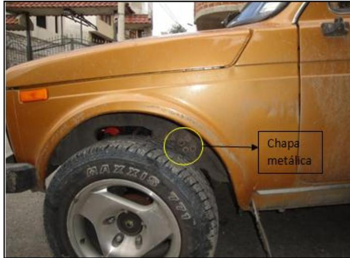
Figura 73, ubicación de la chapa metálica
