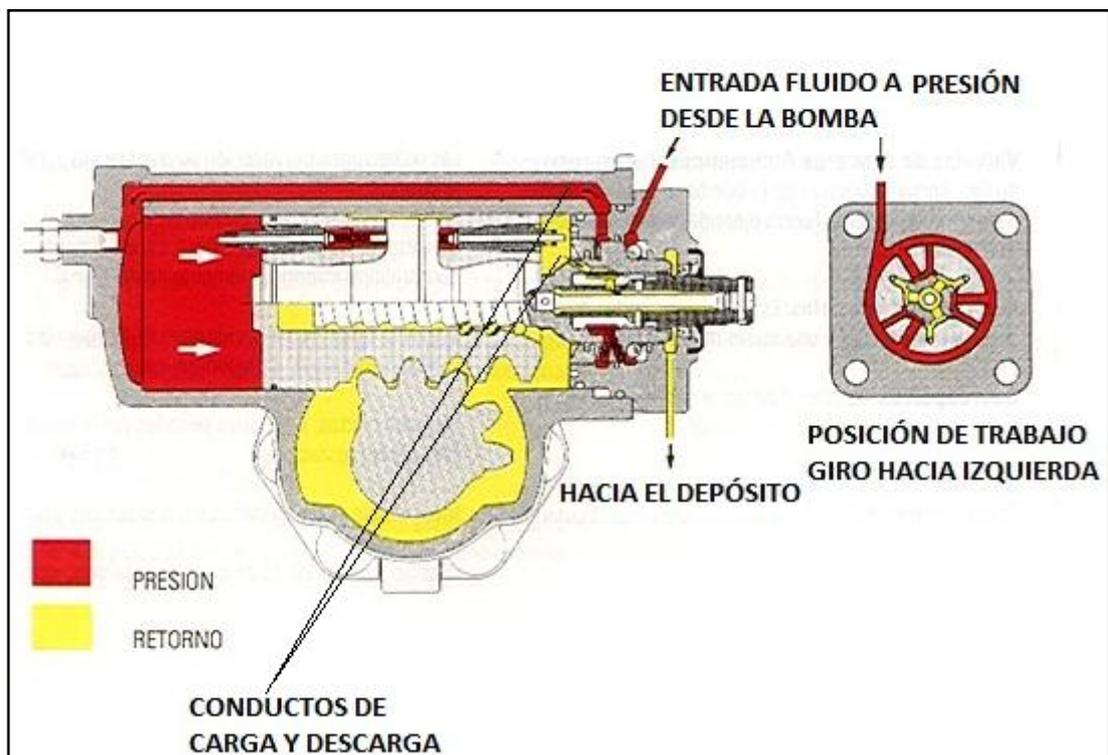
Figura 16, funcionamiento de la válvula rotativa sobre la caja de dirección hidráulica
