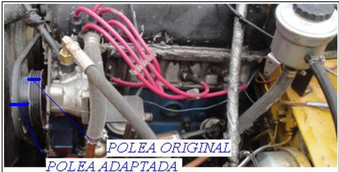
Figura 81, adaptación de una nueva polea sobre la bomba
