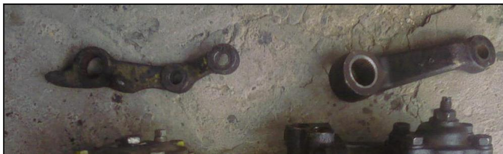
**Figura 77, diferencia de brazo pitman**
