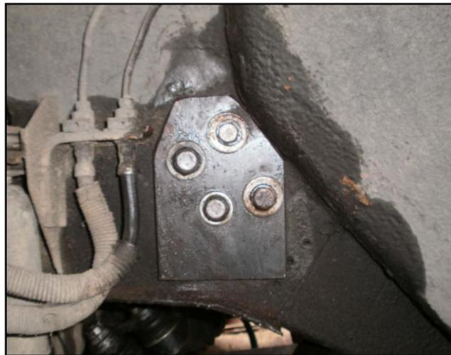
Figura 74, chapa metálica de sujeción
