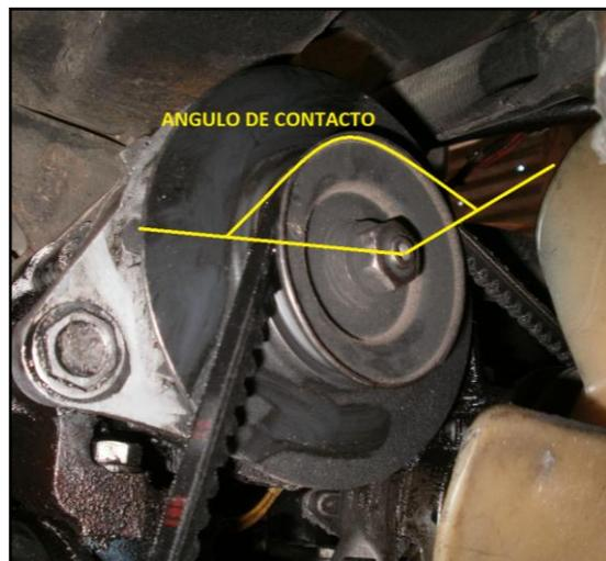
Figura 88, contacto en polea alternador
