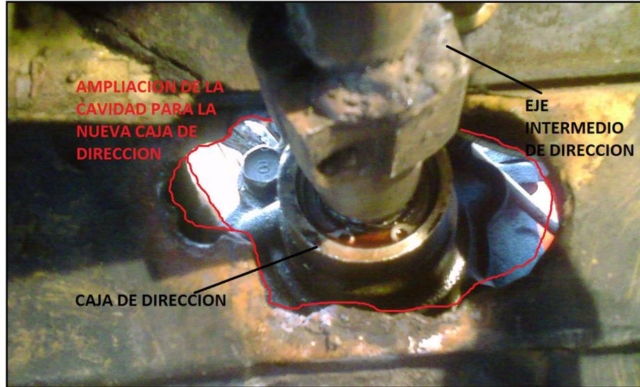
**Figura 63, ampliación de la cavidad para la caja de dirección**
