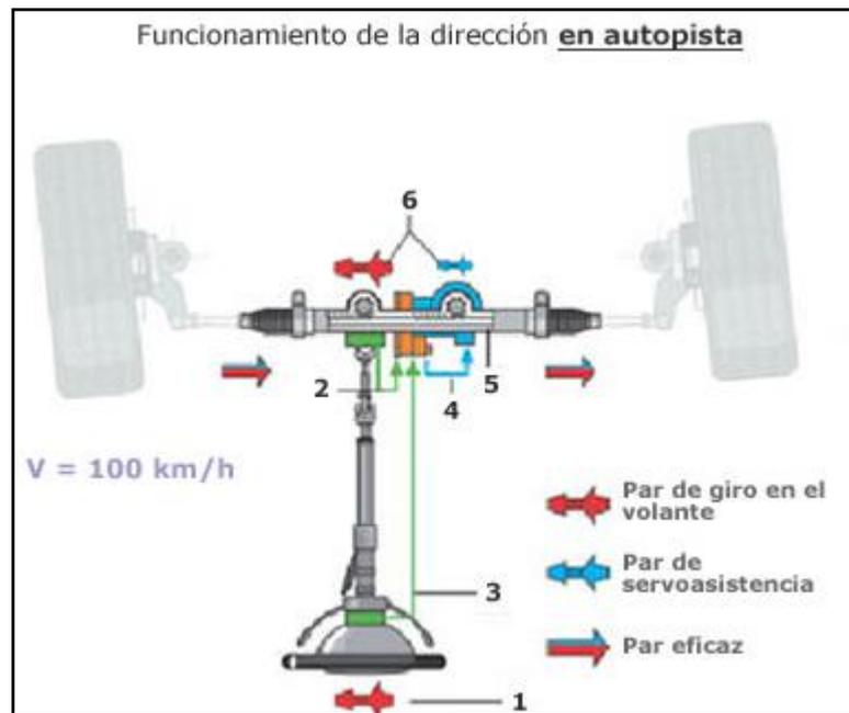
Figura 22, funcionamiento asistencia electrónica en maniobras a altas velocidades
