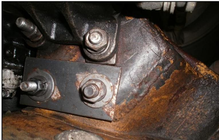
**Figura 76, pernos de sujeción al compacto del vehículo**
