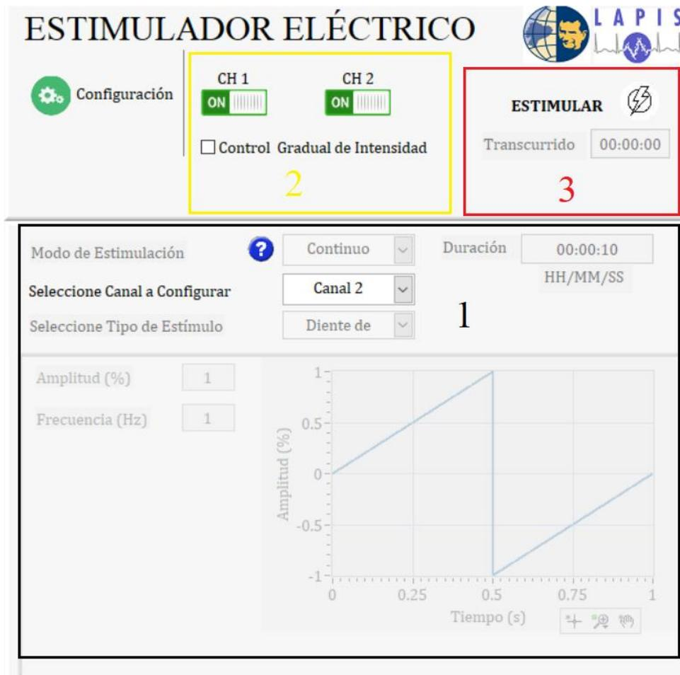
Figura 2.37. Interfaz del estimulador eléctrico generada el LabVIEW y dividida en sus respectivas secciones.
