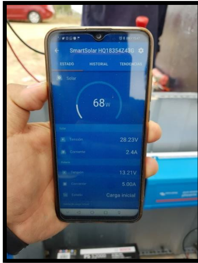
Figura 86: Toma de datos de la tensión, corriente y potencia del sistema solar, fuente: Los Autores.
