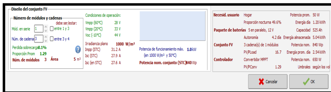
Figura 63: Advertencias del conjunto FV del sistema fotovoltaico, fuente: Los Autores & (PVSYSY, 2020).
