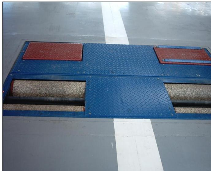
**Figura: 1.5.** Frenómetro y banco de suspensiones. **Fuente:** Autor
