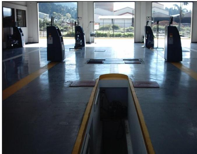
**Figura: 1.4.** Fosa de inspección y detector de holguras. **Fuente:** Autor
