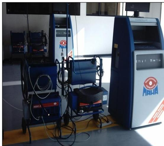
**Figura: 1. 3.** Opacómetro y analizador de gases. **Fuente:** Autor
