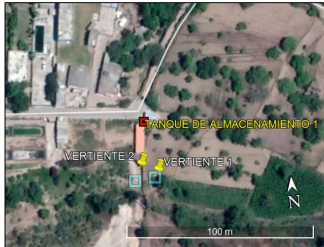
**Nota:** Ubicación de fuentes de captación y tanque de almacenamiento del sistema de agua.
