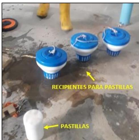
**Nota:** Proceso de Cloración del agua en el Tanque 1. Elaborado por: Los autores
