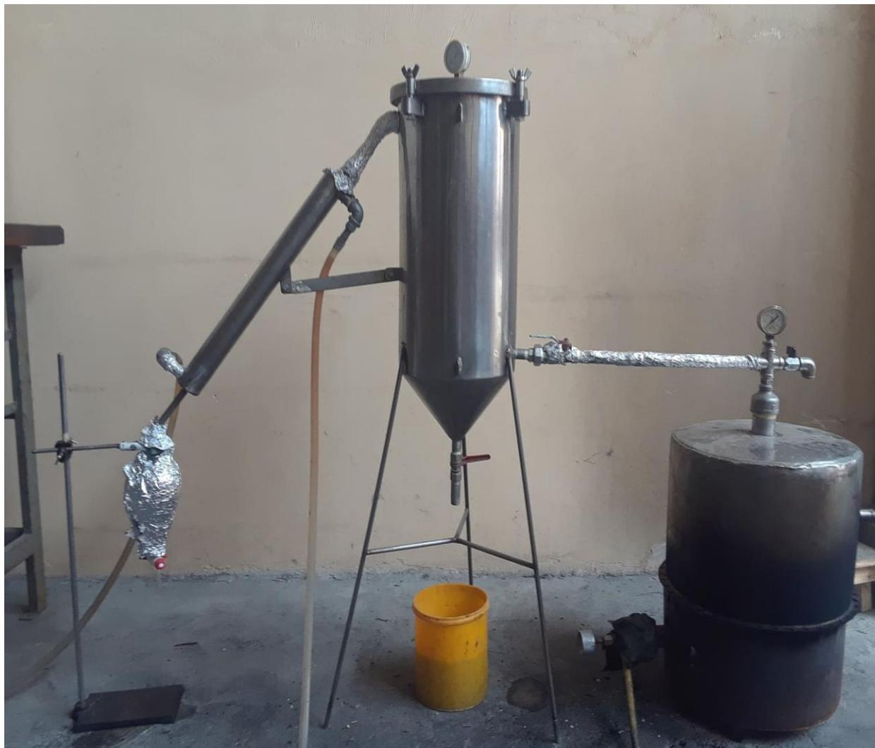
Equipo para destilación de arrastre de vapor con capacidad de destilar 2 kg en un tiempo de 2 horas.
