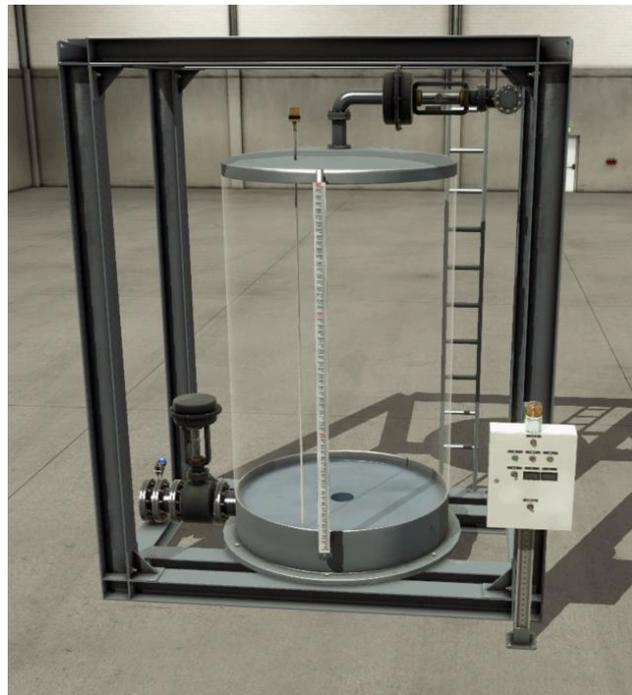
Figura 6.51 Entorno para el control de nivel.
