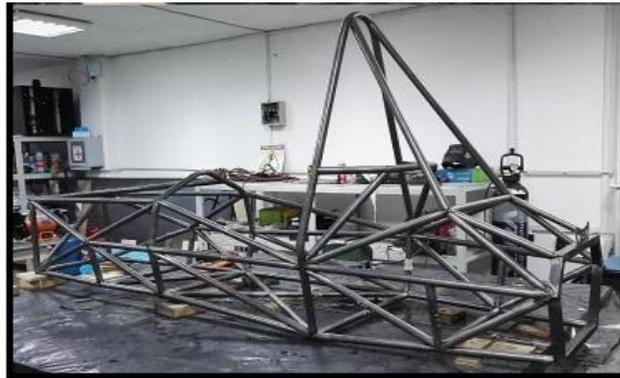
*Figura 4: Chasis Tubular del Equipo UPS (EB17)*
