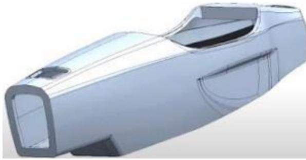
**Figura 30:** Vista Isométrica del Monocasco Mythen AMZ.
