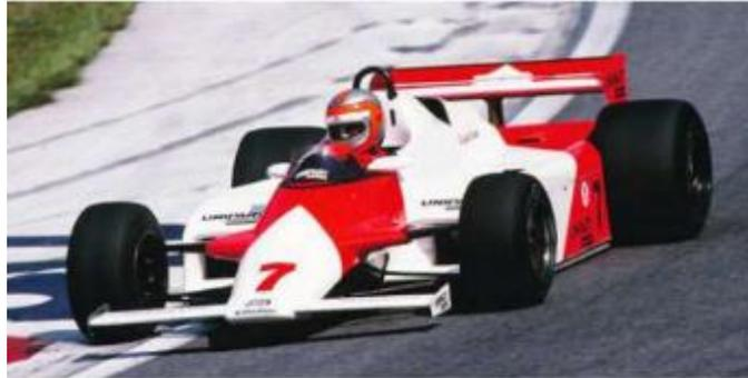
*Figura 3: MP4/1, Primer Monocoque Fabricado en Materiales Compuestos*
