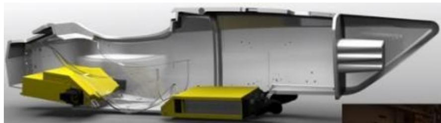
**Figura 26:** Distribución de Elementos del Monocasco Mythen AMZ.
