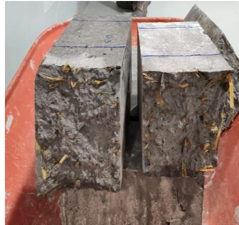
Figura 4. Ensayo destructivo de vigas.
