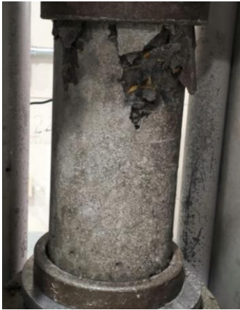
Figura 3. Ruptura de cilindro con incorporación de paja toquilla.
