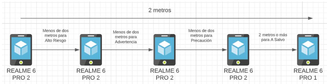
Figura 25 Esquema 2: distancia para pruebas entre dos teléfonos celulares.
