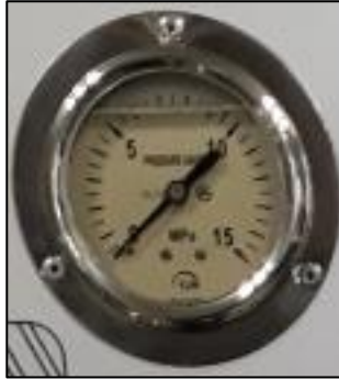
Figura 73: Manómetro de presión del aceite de freno para cada rueda.
