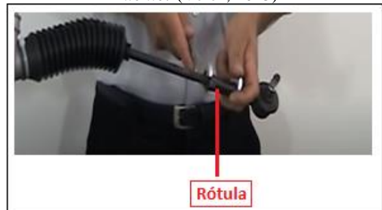
Figura 9: Desmontaje de la rótula. Fuente: (Veloz, 2013)
