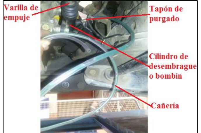
Figura 65: Circulación de líquido de frenos.
