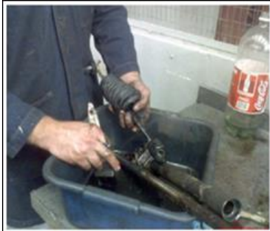
Figura 21. Limpieza de los elementos de la cremallera.
