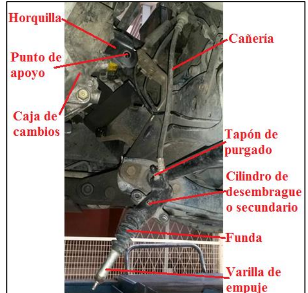
Figura 44: Cilindro de desembrague o bombín.
