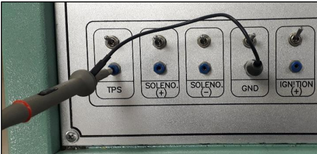
Figura 4: Terminal de verificación – conexión osciloscopio. Fuente: (DAE SUNG G-3 CO., s.f.)
