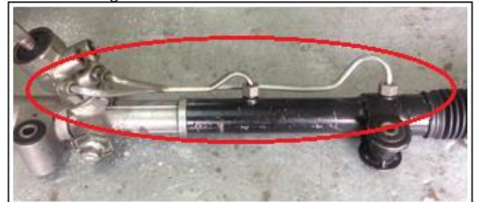
Figura 13: Cañerías de la cremallera.
