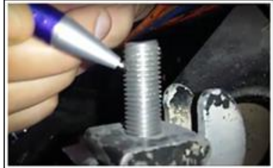
Figura 31. Conteo del número de hilos del perno de calibración de altura. Fuente: (Cueva, 2019)
