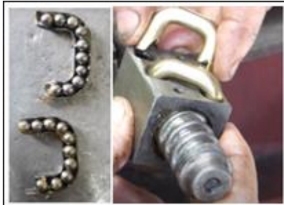
Figura 33. Colocación de las bolas en las hileras.
