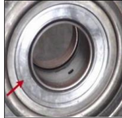
Figura 62: Tambor de reversa. Fuente: Transmisiones Automáticas.
