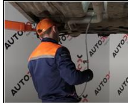
Figura 55. Retiro del cable de freno de estacionamiento.
