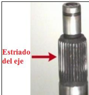
Figura 65: Estriado del eje de la turbina. Fuente: Transmisiones Automáticas.
