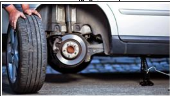
Figura 9. Extracción de la llanta delantera.
