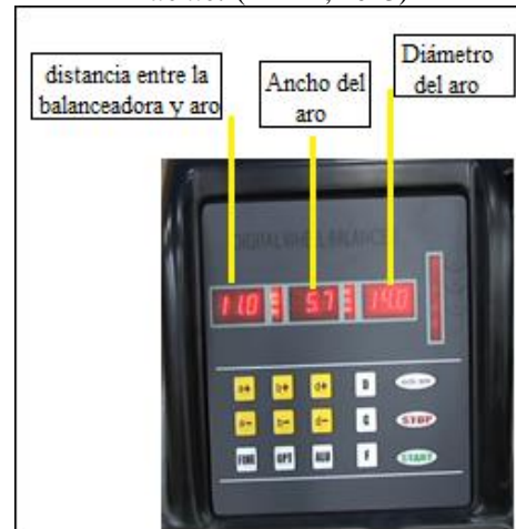
Figura 40. Pantalla de la balancadora. Fuente: (LTDA, 2013)
