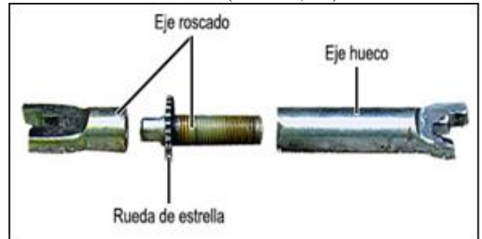
Figura 42. Limpieza del mecanismo de calibración.
