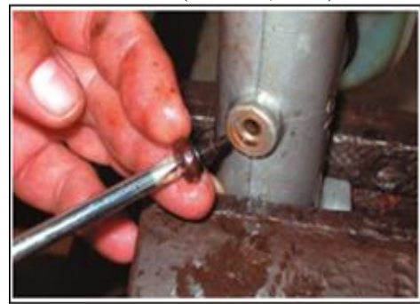
Figura 70. Tornillo de sujeción del pistón secundario.
