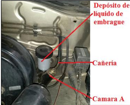
Figura 70: Verificar el circuito hidráulico.
