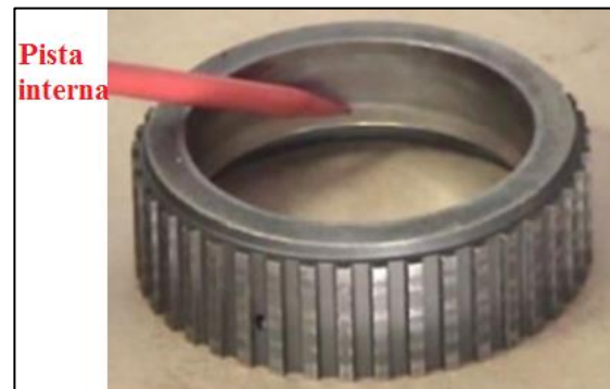
Figura 46: Comprobación del embrague unidireccional.
