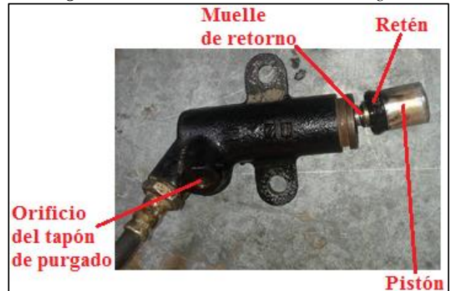
Figura 46: Pistón del cilindro de desembrague.
