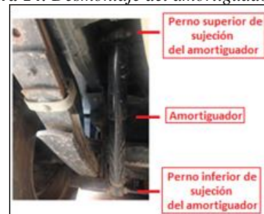
Figura 14. Desmontaje del amortiguador.
