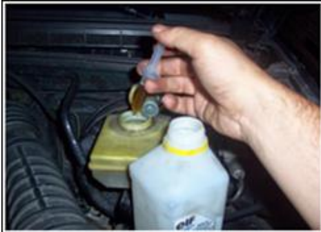
Figura 53. Drenado del líquido de frenos del cilindro maestro.
