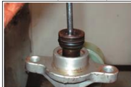
Figura 57. Extracción del pistón primario.
