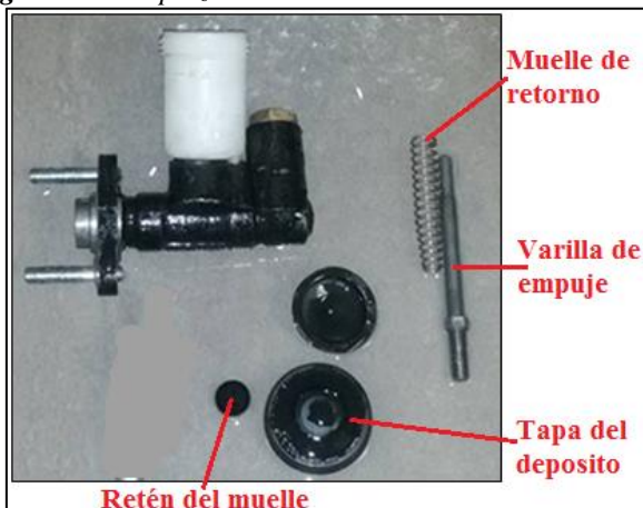
Figura 42: Limpieza de los elementos del cilindro maestro.
