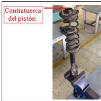
Figura 23. Colocación del sistema McPherson en una entenalla.
