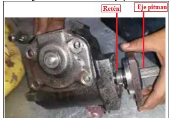
Figura 12: Protección del eje pitman.
