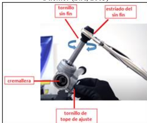
Figura 38. Ajuste de la cremallera.
