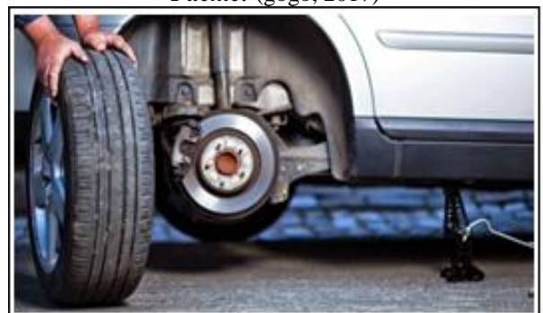
Figura 46. Extracción de la llanta delantera.
