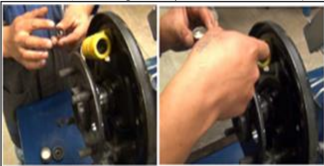
Figura 43. Lubricación del interior del cilindro.
