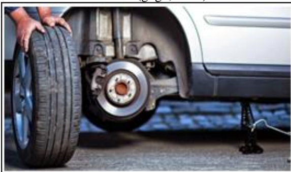
Figura 5. Extracción de la llanta delantera
