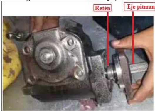
Figura 38: Protección del eje pitman.
