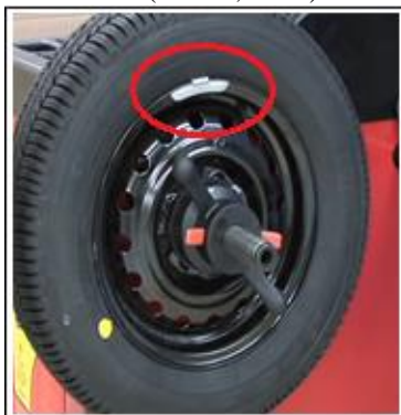
Figura 43. Colocación de pesas. Fuente: (LTDA, 2013)
