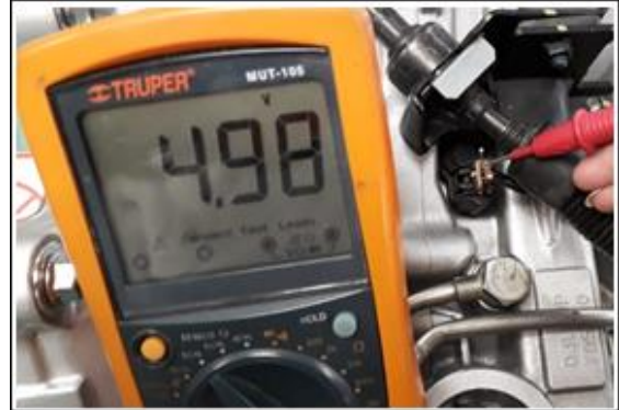
Figura 16. Comprobación de terminal de señal del sensor.
