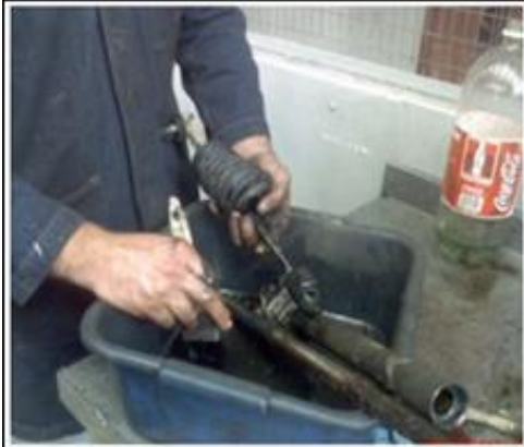
Figura 19. Limpieza de los elementos de la cremallera.
