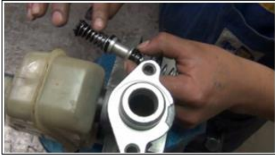
Figura 67. Lubricación de los elementos internos de la bomba
