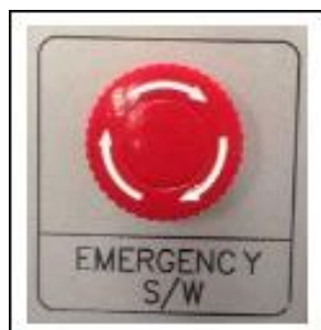
Figura 21. interruptor de emergencia
