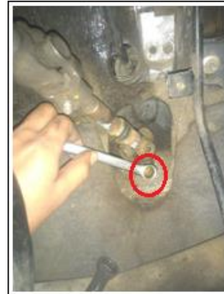
Figura 10. Pernos de la columna de dirección.
