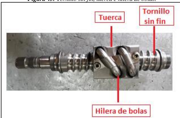
Figura 43: Tornillo sin fin, tuerca e hilera de bolas.
