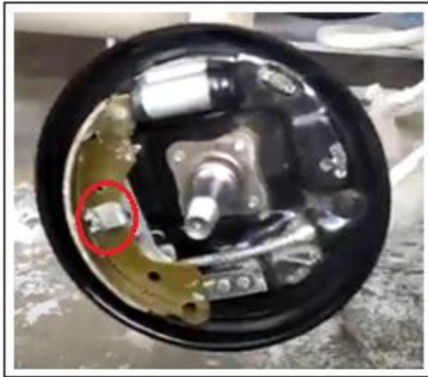
Figura 64. Colocación del seguro de la zapata.
