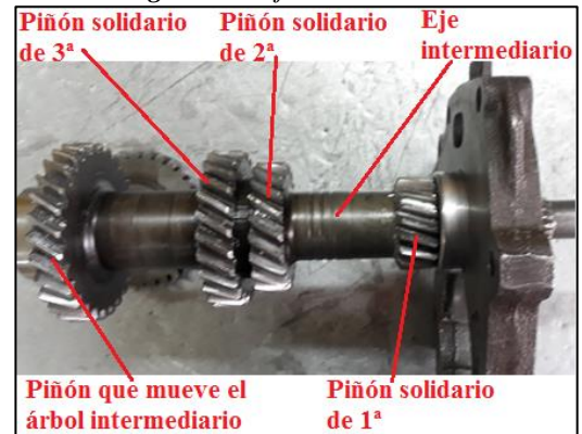
Figura 60: Eje intermedio.
