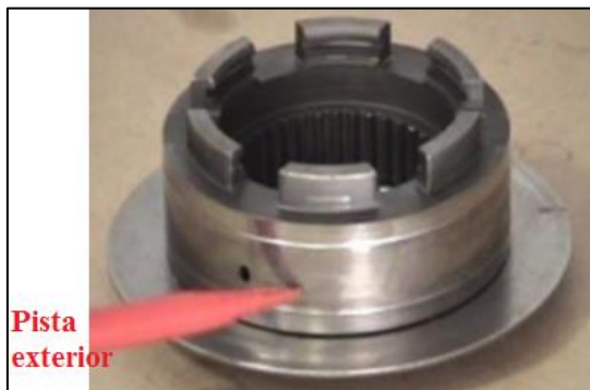
Figura 45: Comprobación del embrague unidireccional.
