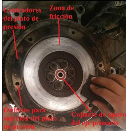
Figura 53: Limpieza del volante de inercia.
