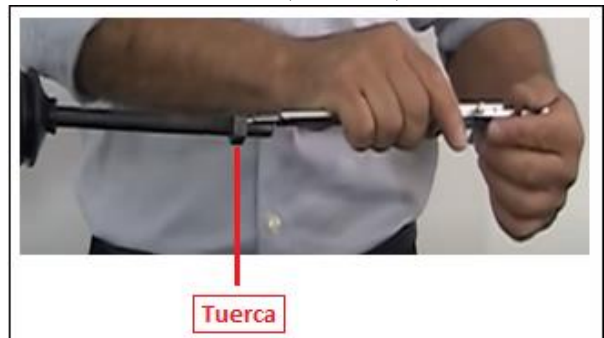
Figura 10: Medición de la distancia de la tuerca. Fuente: (Veloz, 2012)
