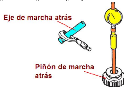
Figura 53: Holgura de engranaje de marcha atrás.
