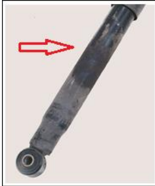
Figura 11. Amortiguador con fuga.
