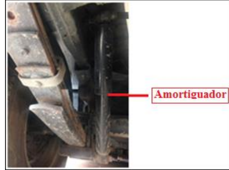
Figura 33: Colocación del amortiguador.
