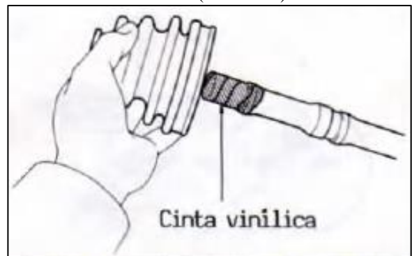
Figura 54: Montaje del guardapolvo. Fuente: (TOYOTA)
