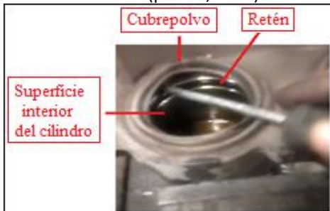
Figura 18. Extracción de los pistones de freno.
