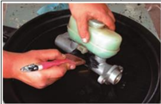
Figura 60. Lavado del cuerpo de la bomba.
