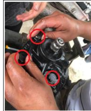
Figura 85. Pernos de sujeción del sin fin.
