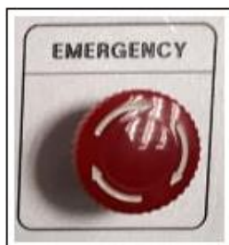
Figura 48. Interruptor de emergencia
