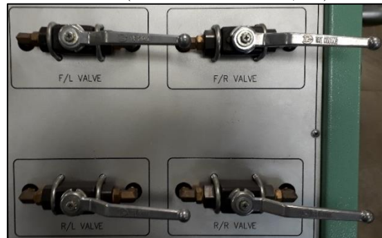
Figura 69: Válvulas de interceptación.
