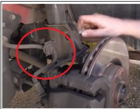
Figura 41. Conexión de cañerías.
