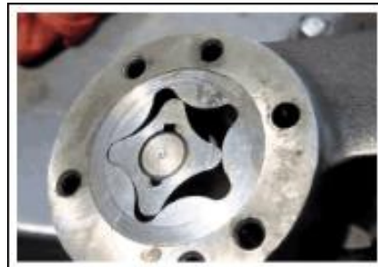
Figura 2. Bomba tipo gerotor Fuente: (Machukon, 2018)
