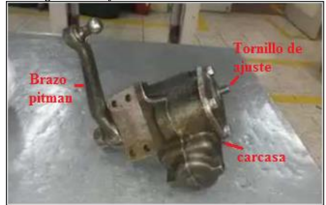
Figura 10. Caja de dirección con hilera de bolas.
