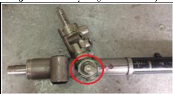
Figura 14: Tuerca que regula tensión del eje.
