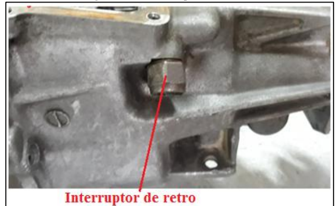
Figura 42: Interruptor de retro.
