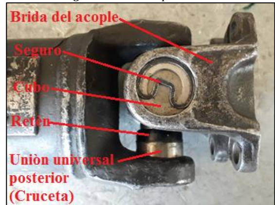
Figura 19: Junta tipo cardán.
