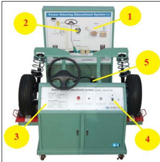
Figura 2: Material Didáctico - Sistema Electrónico de Dirección Asistida. Fuente: (DAE SUNG G-3 CO., s.f.)
