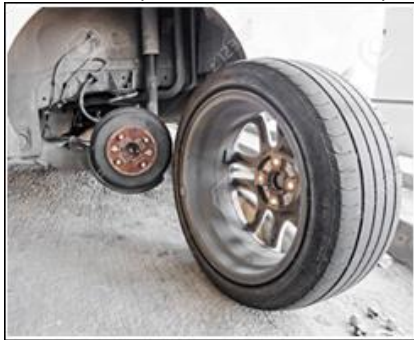
Figura 31. Desmontaje de la rueda trasera del vehículo
