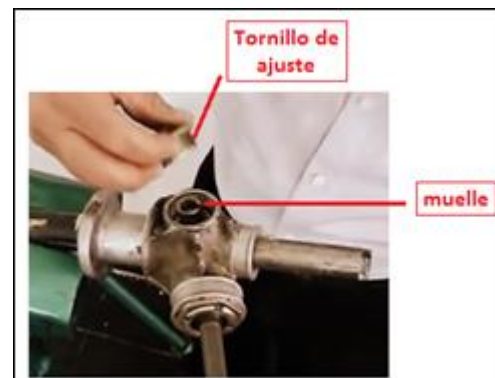
Figura 31. Tornillo de ajuste con su muelle.
