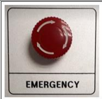
Figura 21. Interruptor de emergencia
