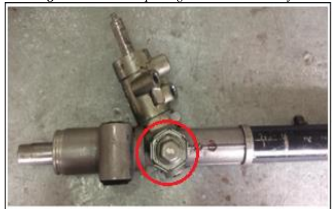
Figura 44: Tuerca que regula la tensión del eje.
