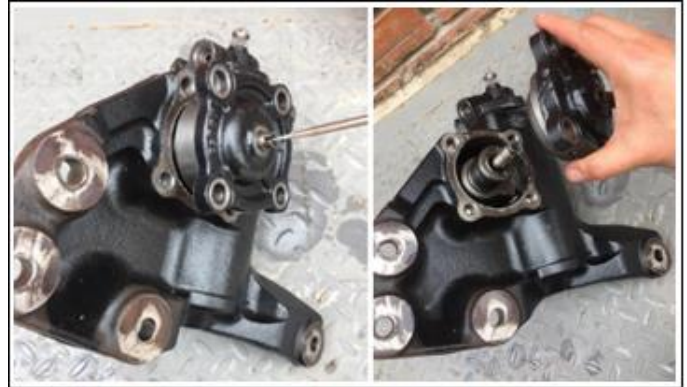
Figura 51: Protección del eje pitman.
