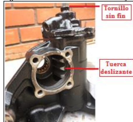
Figura 83. Calibración del tornillo sin fin.
