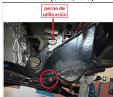
Figura 17. Perno de calibración de altura. Fuente: (Cueva, 2019)
