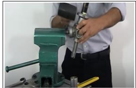
Figura 16. Separación del Tornillo sin fin.
