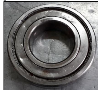
Figura 41: Rodamiento en mal estado.
