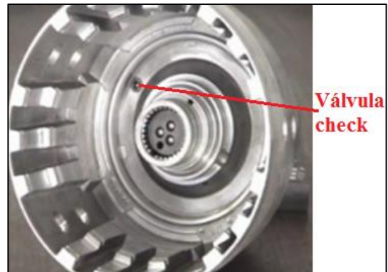
Figura 64: Comprobación del tambor del embrague. Fuente: Transmisiones Automáticas.
