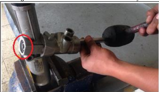
Figura 20: Extracción del rodamiento del sin fin.
