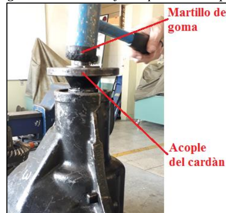
Figura 22: Desmontaje del piñón de ataque.
