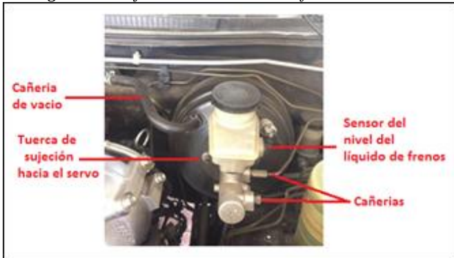
Figura 54. Sujeción de la bomba de frenos en el servo.
