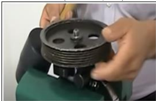
Figura 97: Desmontaje de la polea. Fuente: (Hidráulicos, 2012)
