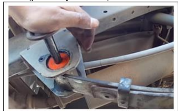
Figura 29: Fijación del soporte delantero.
