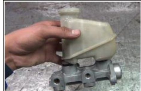
Figura 65. Depósito del líquido de frenos. Fuente: (Montenegro Guallpa & Navas Neira, 2012)
