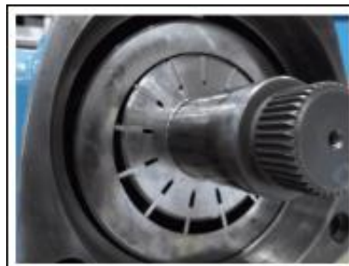
Figura 3. Bomba tipo aspas variables Fuente: (Machukon, 2018)
