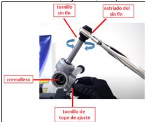
Figura 45: Calibración de la cremallera. Fuente: (Obyco S.A, 2015)
