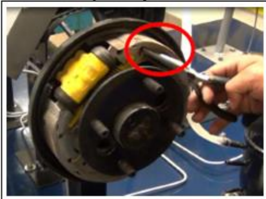
Figura 38. Seguros de sujeción de las zapatas.
