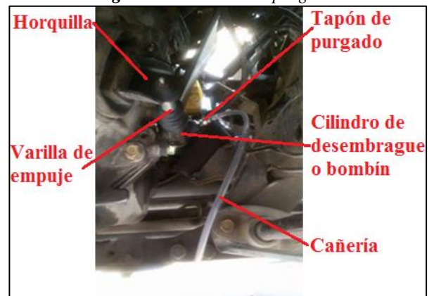
Figura 63: Proceso de purgado.
