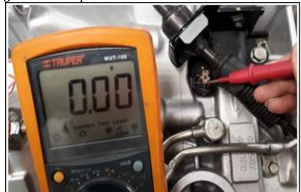
Figura 14. Comprobación de terminal de masa del sensor.
