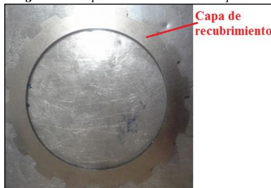
Figura 50: Inspección de las arandelas planas.
