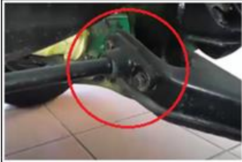
Figura 30. Pernos de la barra de torsión al plato de suspensión inferior. Fuente: (Cueva, 2019)
