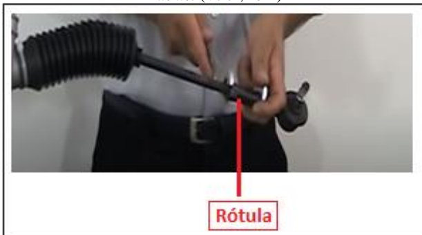
Figura 9 : Desmontaje de la rótula. Fuente: (Veloz, 2012)
