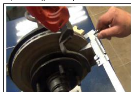
Figura 24. Comprobación del espesor del disco.
