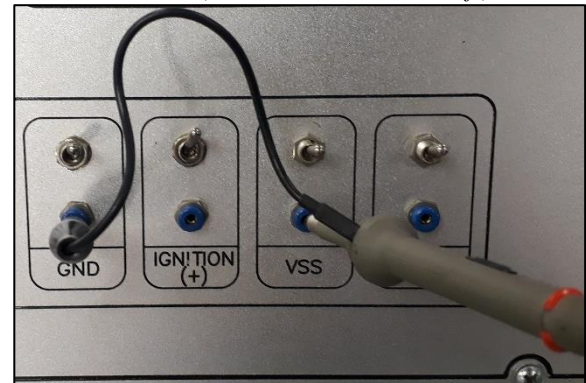
Figura 11: Terminal de verificación – conexión osciloscopio.
