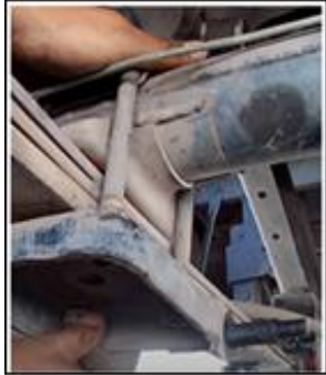
Figura 32: Sujeción del eje con la Ballesta.
