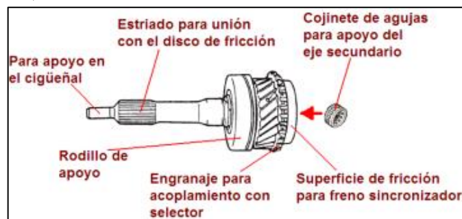
Figura 3: Eje primario.
