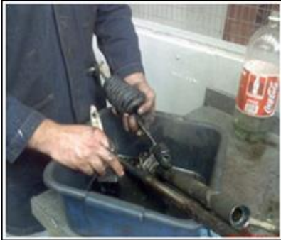
Figura 22. Limpieza de los elementos de la cremallera.
