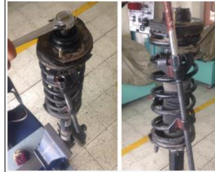
Figura 40. Contratuerca del pistón y compresor de muelles.
