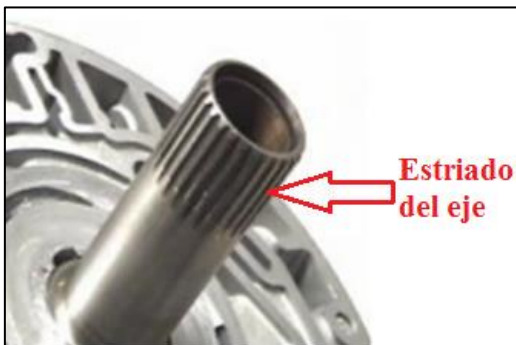
Figura 59: Comprobación del estriado de la bomba. Fuente: Transmisiones Automáticas.
