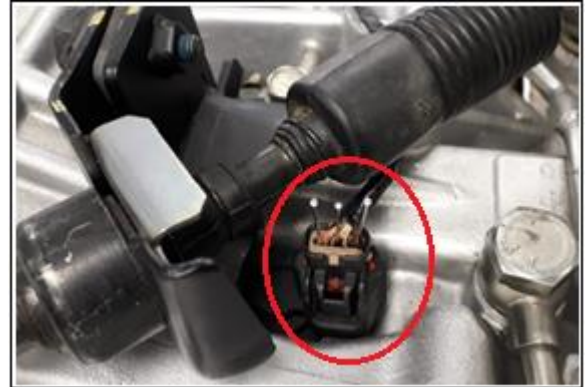
Figura 12. Conexión de alfileres a los terminales del sensor.
