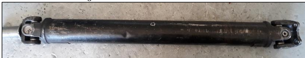
Figura 32: Armado del árbol de transmisión.
