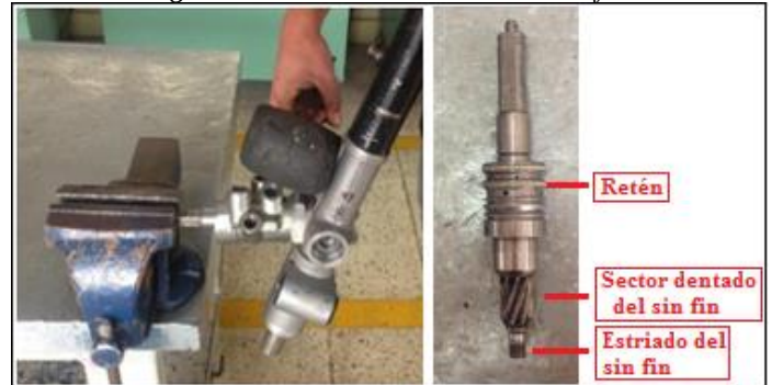
Figura 17: Extracción del tornillo sin fin.
