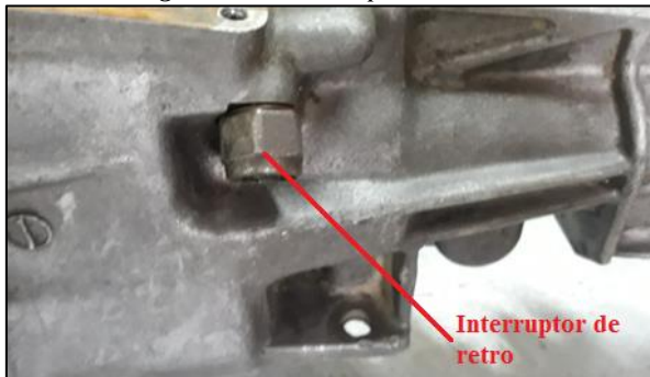
Figura 117: Interruptor de retro.
