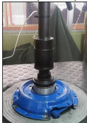
Figura 26: Fuerza de apriete en el plato de presión.
