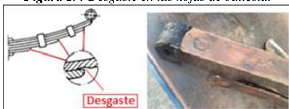
Figura 19: Desgaste en las hojas de ballesta.
