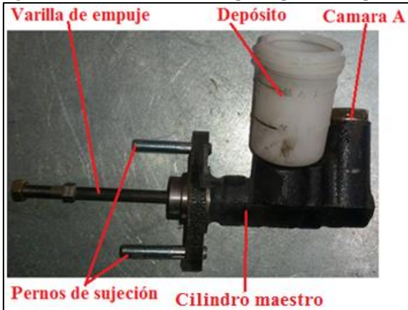
Figura 38: Cilindro maestro o principal desacoplado.
