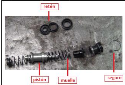
Figura 62. Partes internas del cilindro maestro. Fuente: (Montenegro Guallpa & Navas Neira, 2012)
