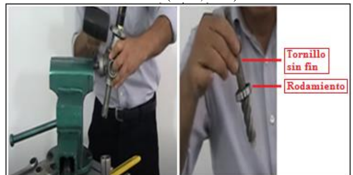
Figura 18. Separación del Tornillo sin fin.
