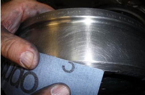
Figura 30. Lijado de la superficie del disco.
