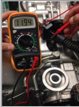
Figura 15. Comprobación de terminal de alimentación del sensor.
