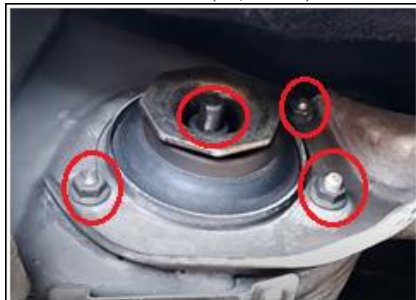
Figura 21. Pernos de sujeción del amortiguador al chasis.
