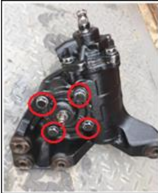
Figura 50: Protección del eje pitman.
