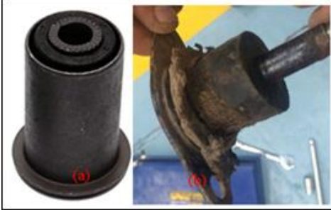
Figura 21: a) Buje en perfecto estado, b) Buje desgastado
