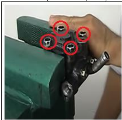
Figura 99: Tapa de la bomba hidráulica. Fuente: (Hidráulicos, 2012)
