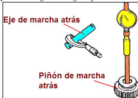
Figura 85: Holgura de engranaje de marcha atrás.
