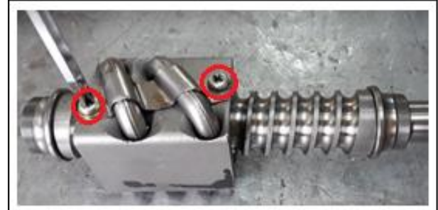
Figura 59. Sujeción de las hileras de bolas.
