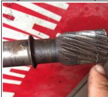
Figura 21. sector dentado del sin fin.
