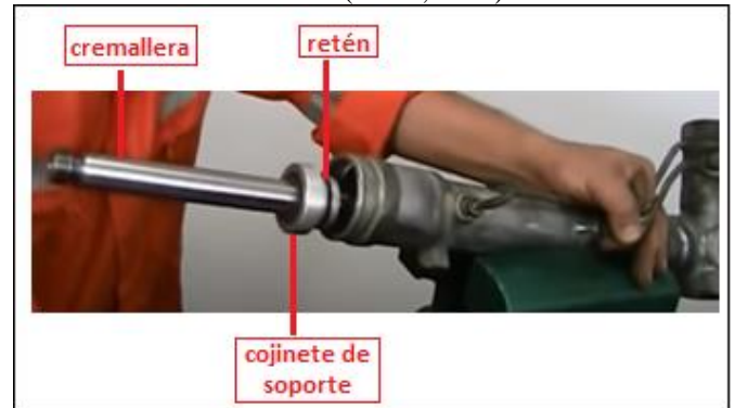
Figura 19: Extracción de la cremallera.
