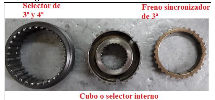
Figura 62: Desensamble de selector de 3ª y 4ª.
