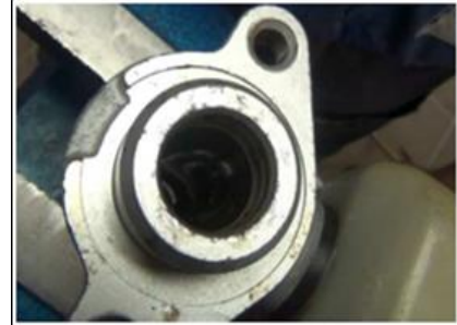
Figura 63. Ralladuras en las paredes interiores del cilindro. Fuente: (Montenegro Guallpa & Navas Neira, 2012)
