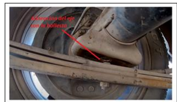
Figura 31: Alineación del eje con la Ballesta.
