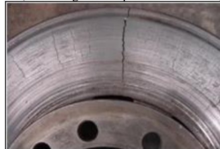
Figura 22. Cristalización del disco de freno.
