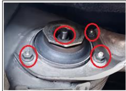
Figura 42. Pernos de sujeción del amortiguador al chasis.
