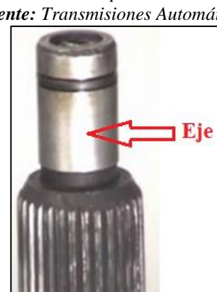
Figura 66: Comprobación del eje donde sella el convertidor de par. Fuente: Transmisiones Automáticas.
