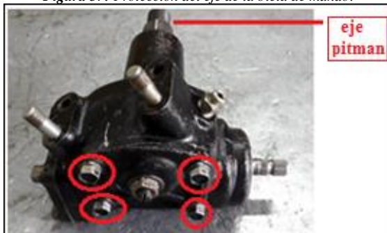
Figura 37: Protección del eje de la biela de mando.
