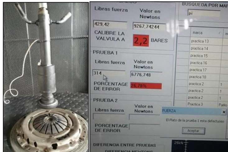
Figura 11: Ensayos sobre Platos de Presión.
