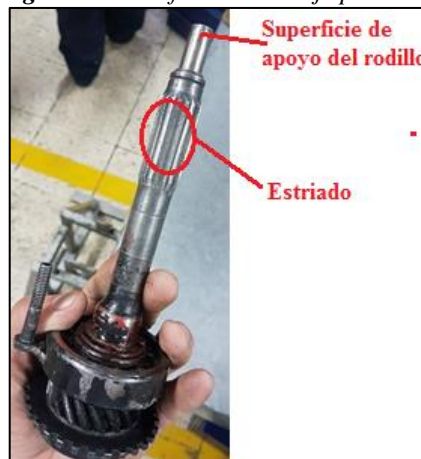
Figura 28: Verificación del eje primario.
