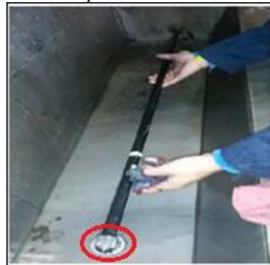
Figura 29. Limpieza de la barra de torsión.
