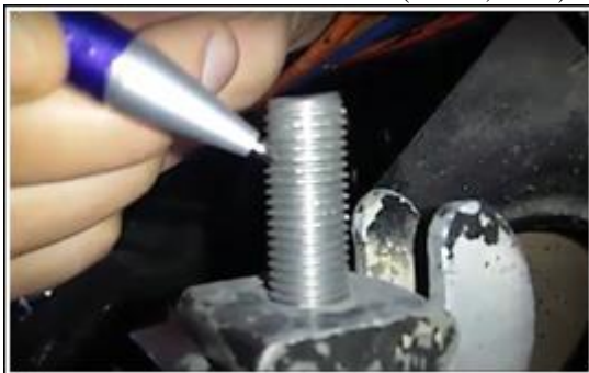
Figura 16. Conteo del número de hilos del perno de calibración de altura. Fuente: (Cueva, 2019)
