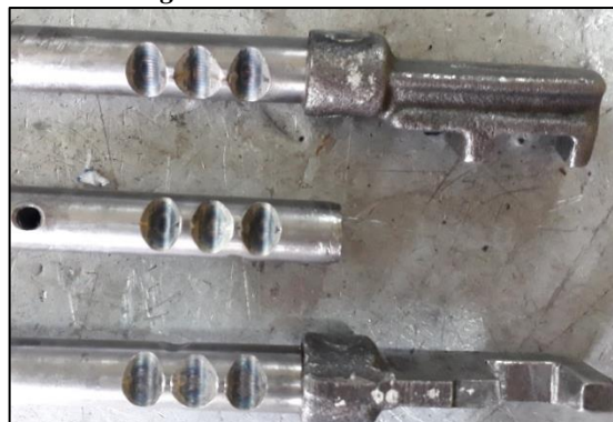
Figura 45: Varillas de mando.
