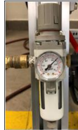
Figura 28. Presión para el funcionamiento del freno de aire electrónico.
