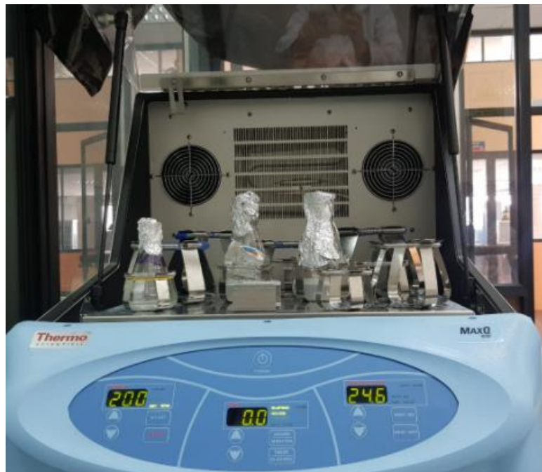
Anexo A.5: Matraces de PE de alta y baja densidad en el orbital con agitación de 200 rpm.
