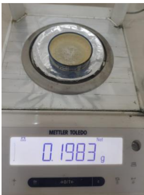
Anexo A.11: Peso de la muestra de PE de alta densidad sometido a biodegradación.
