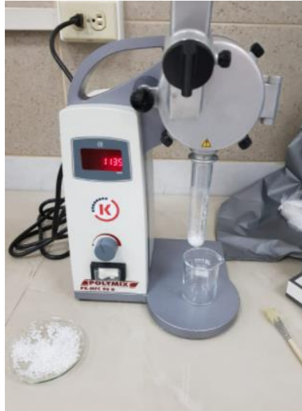
Anexo A.3: Triturado del PE de alta y baja densidad mediante un molino con una rejilla de 2mm.
