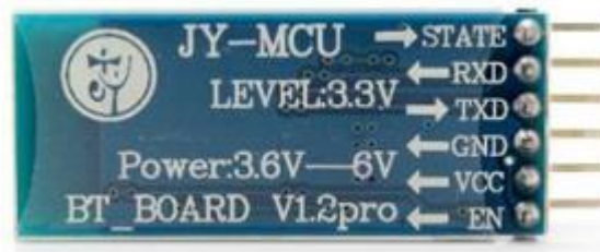
Figura 1.14 Pines de conexión HC-05. Fuente: [37]
