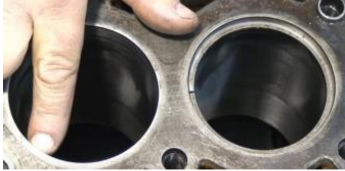
Figura 2 Comprobación de luz de puntas del segmento o Ring. Practicas UPS
