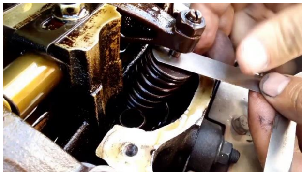
Figura 14 Calibración de taques mecánicos. Tomado de la revista Motor
