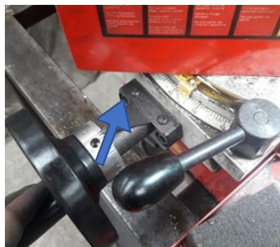
Figura 6 Ángulo de Rectificación de válvulas. Autor
