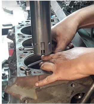
Figura 58 Medición del desgaste en los cilindros. Autor
