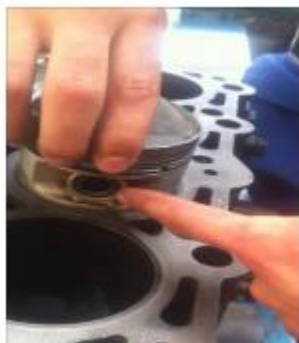
Figura 1 Comprobación de la holgura entre pistón y cilindro. Practicas UPS
