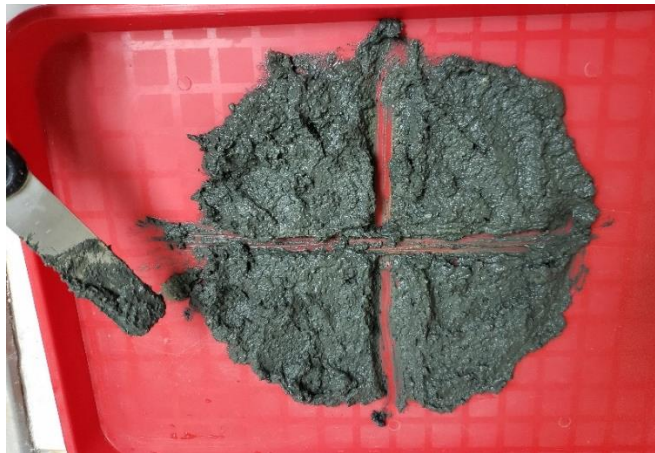
Figura 14 Método del cuarteo y subcuarteo en muestras de sedimento. Fuente: La autora
