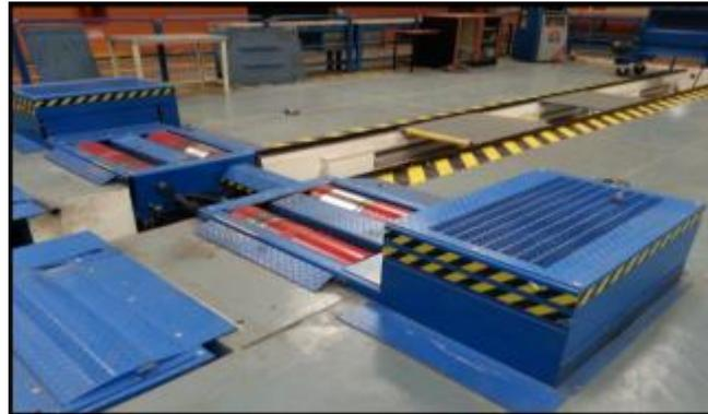
Figura 14: Banco Dinamométrico
