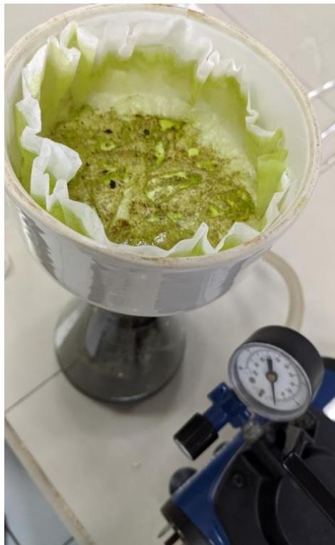
*Ilustración 8. Filtración de extracto alcohólico.*
