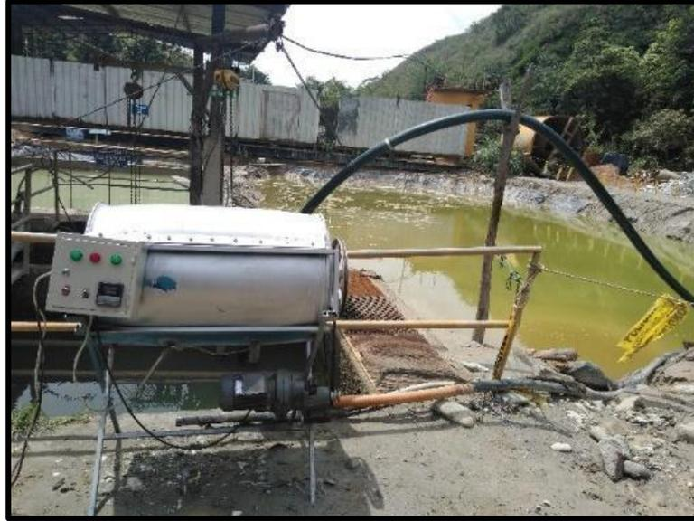
**Figura 18.** Sistema de biodiscos funcionando
