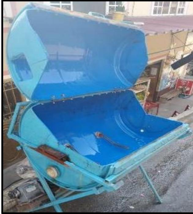
**Figura 16.**Sistema de biodiscos en fase de mantenimiento
