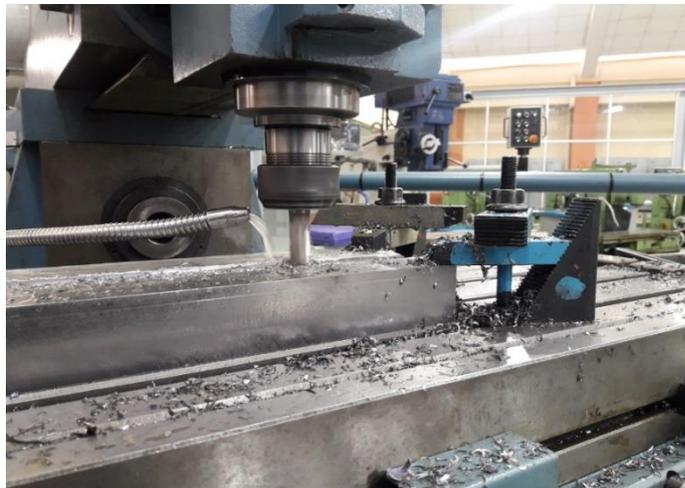
Figura 63. Ranurado en la base del eje X
