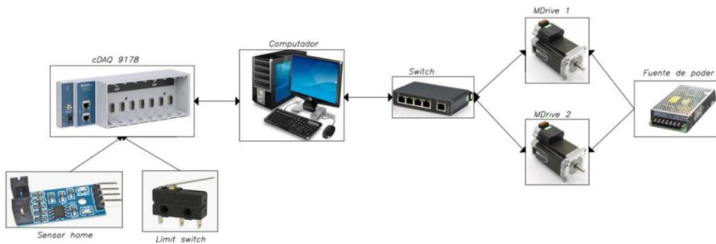
Figura 50. Esquema de control
