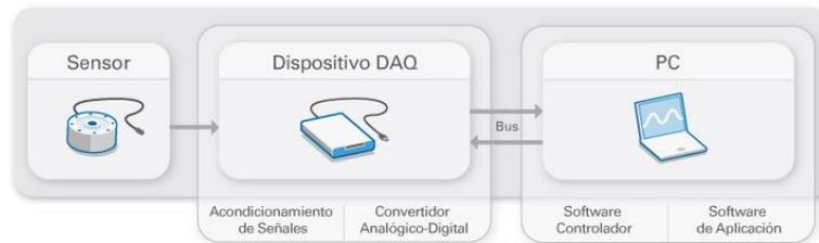
Figura 8. Estructura del sistema DAQ[24]
