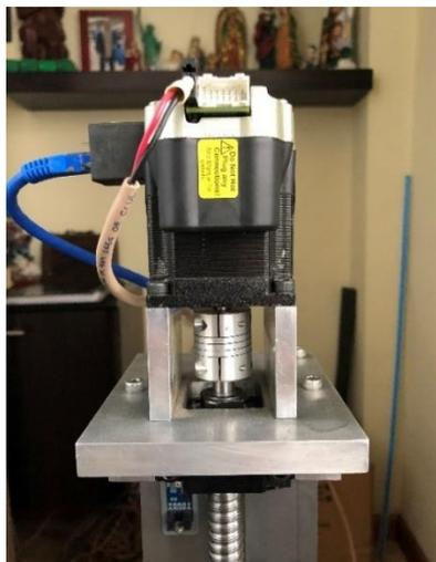
Figura 61. Sistema de transmisión
