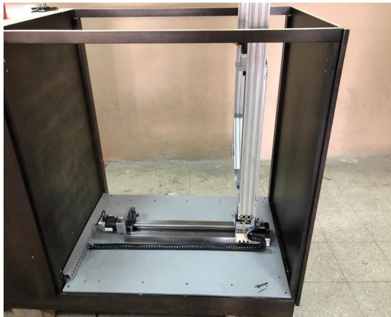
Figura 65. Montaje de la estructura del eje Y
