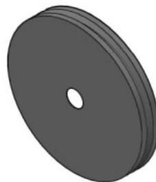
Esquema 24. Diseño de la polea 6" en AutoCAD en 3d
