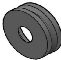
Esquema 23. Diseño de la polea en AutoCAD 3D
