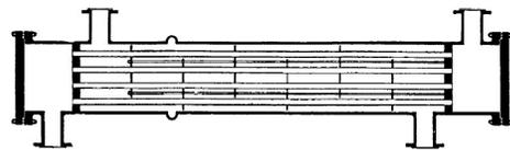
b. Intercambiador Tubular de Cabezal Fijo con Carretes Integrales
