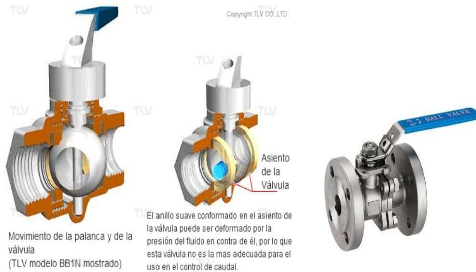
**Figura 43. Válvula de Bola, Cierre Rápido**
