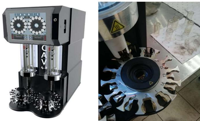
**Figura 53.** *Análisis de Viscosidad, Viscosímetro Automático Cannon CAV 4.2*
