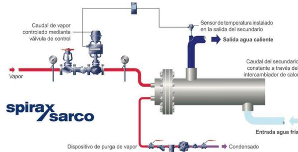
**Figura 24.** Esquema de Una Línea de Vapor para un Intercambiador
