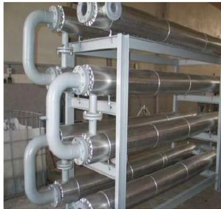
*Figura 21. Intercambiador de Doble Tubo*
