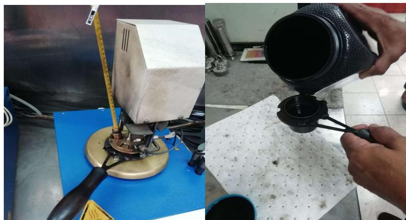
**Figura 54.** *Análisis de Punto de Inflamación, Equipo PMA 4*
