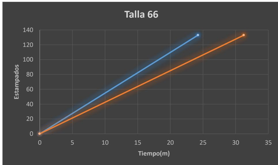
**Figura 5. 7 Comparación de tiempo entre estampados manual y automatizado**
