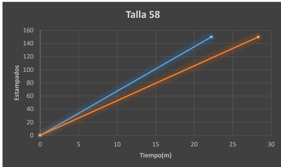
**Figura 5. 3 Comparación de tiempo entre estampados manual y automatizado**
