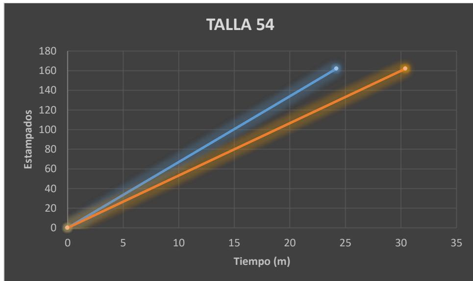
**Figura 5. 1 Comparación de tiempo entre estampados manual y automatizado**
