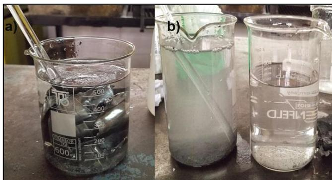
*Imagen 11.* Obtención de Zinc: a) Contenedor de acero en reposo para obtener zinc; b) Agua destilada con Zinc Metálico.
