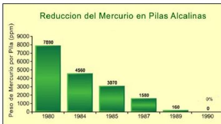
Figura 1. Reducción del Mercurio en Pilas Alcalinas.
