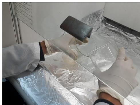
*Imagen 13.* Disolución de  $H_2SO_4$  para obtenerlo en diferentes concentraciones
