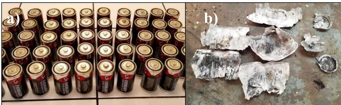
Imagen 9. Recolección y desmantelamiento de pilas: a) Pilas recolectadas post-consumo; b) Contenedor de acero raspado para obtener Zinc.
