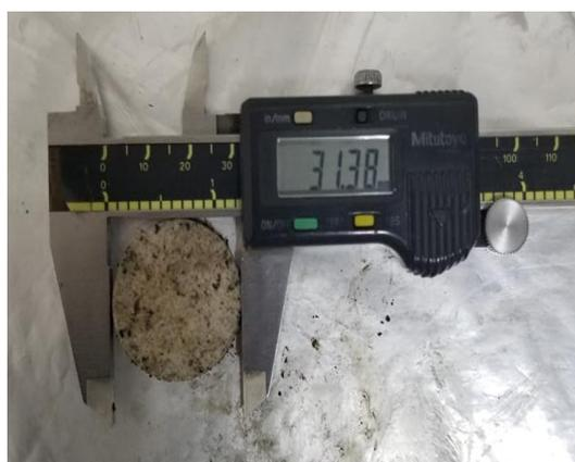
Imagen 33. Medición del diámetro de la pastilla obtenida con ayuda de un calibrador
