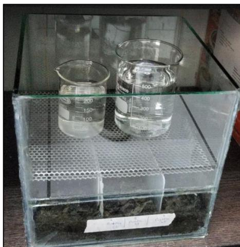
*Imagen 28. Montaje de muestras en desecador para estudio*
