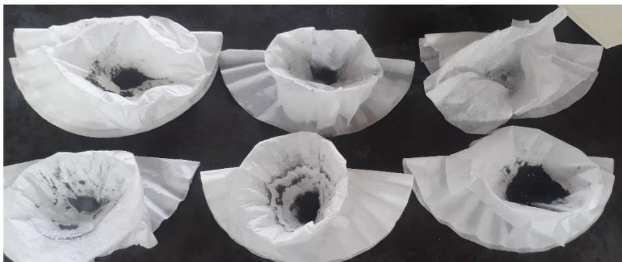
Imagen 12. Sulfato de Zinc obtenido posterior al proceso de filtración
