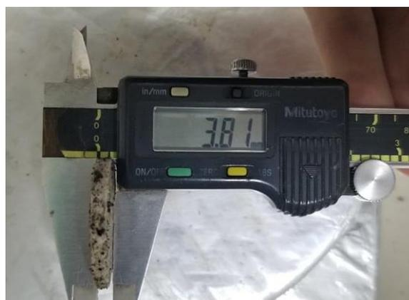
Imagen 34. Medición del espesor de la pastilla obtenido con ayuda de un calibrador
