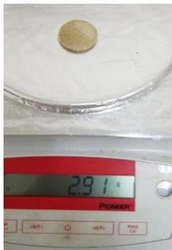
Imagen 35. Pesaje de pastillas en balanza analítica
