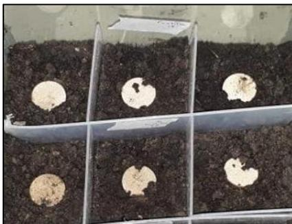
*Imagen 27.* Colocación de muestras de pastillas en sustrato orgánico
