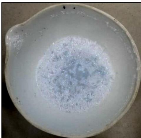
*Imagen 22.* Cristales de BHET obtenidos mediante Glicólisis
