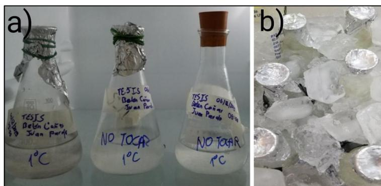
Imagen 21. Refrigeración y congelación de muestras para obtención de BHET
