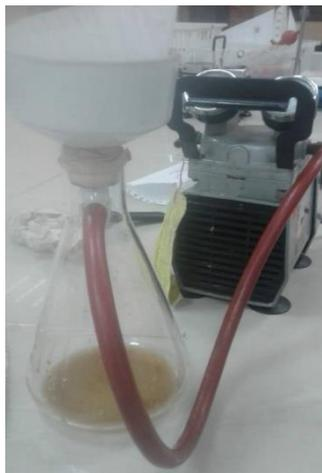
Imagen 26. Filtrado de almidón de plátano mediante una bomba de filtrado
