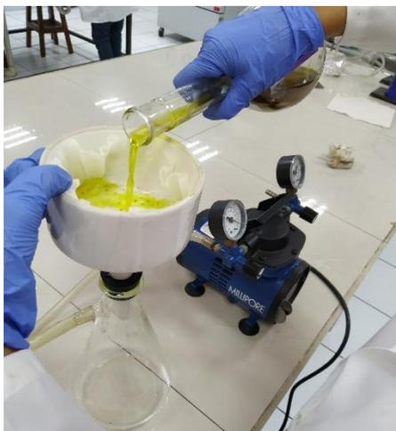
Imagen 2. Filtración al vacío. Fuente: (Autor).
