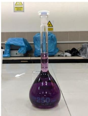
Imagen 3. Solución 0.5 mM DPPH en etanol al 96 %. Fuente: (Autor).
