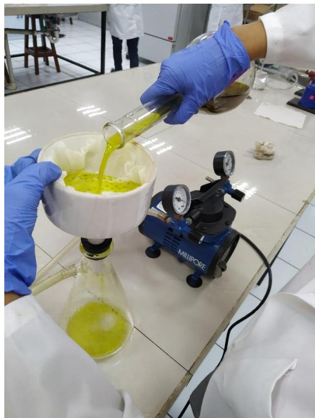
Imagen 15. Filtración al vacío. Fuente: (Autor).
