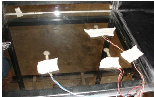
Figura 5.17 Calibración de los sensores en la zona de pruebas
