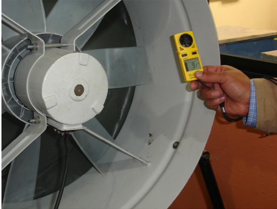
Figura 5.16 Velocidad alcanzada en la salida del túnel de viento
