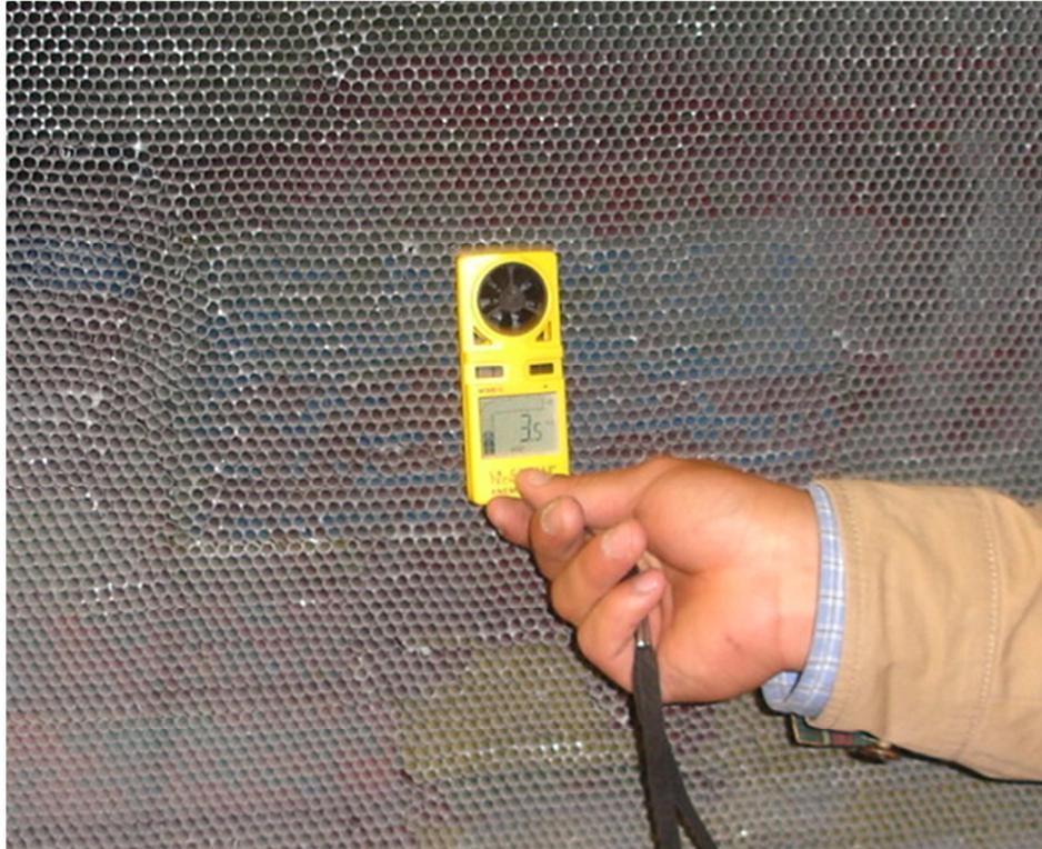
Figura 5.11 Velocidad alcanzada en el centro del direccionador de flujo
