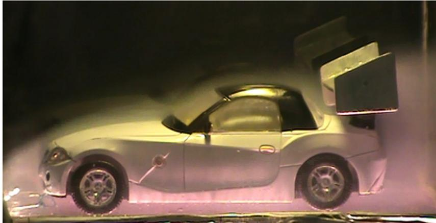
Figura 5.32 Vehículo con alerón sometido a pruebas de capa limite
