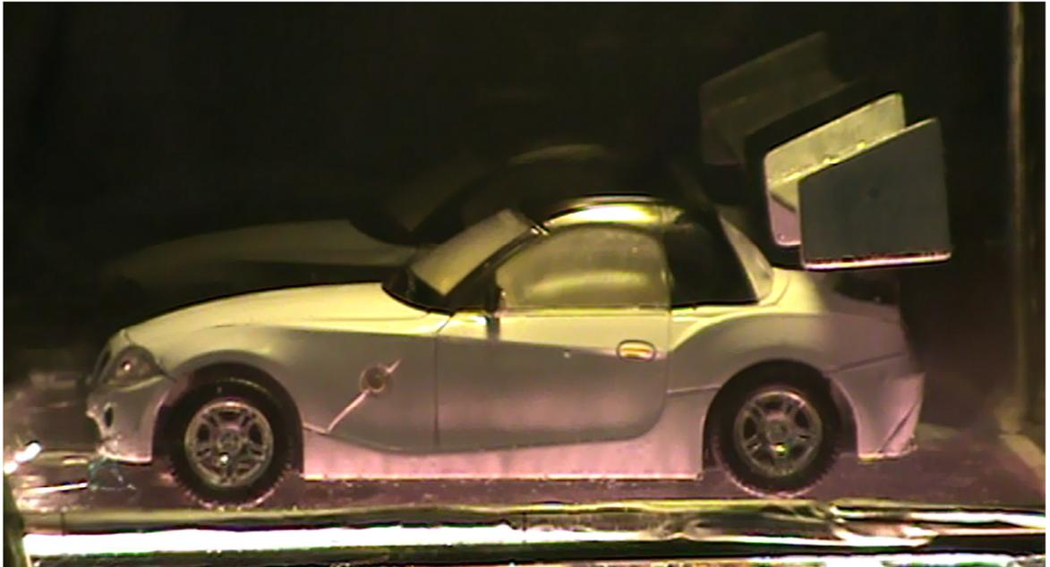
Figura 5.28 Vehículo a escala 1:18 sometido a pruebas de sustentación
