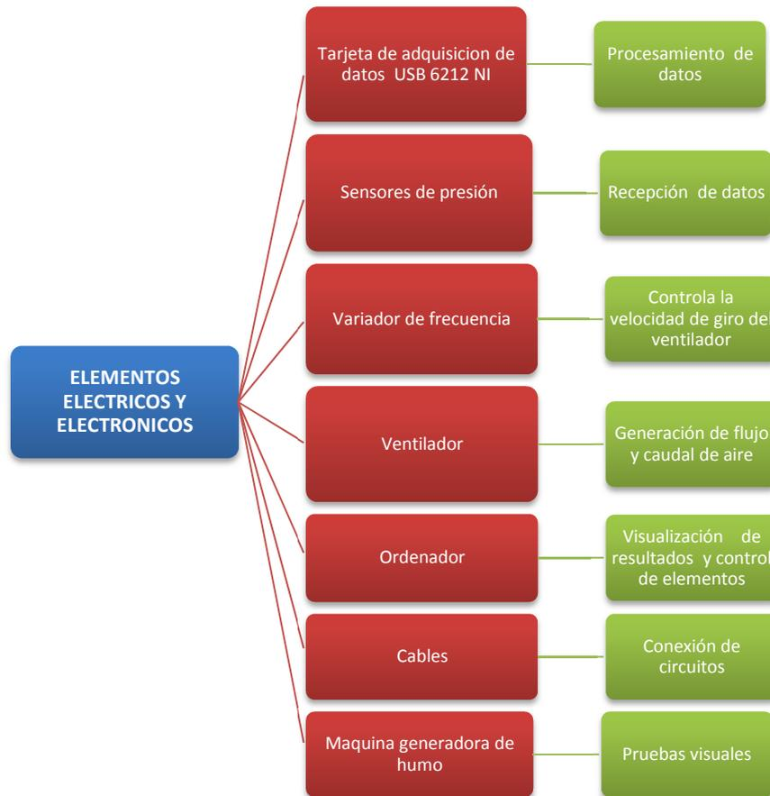
Figura 4.5 Elementos eléctricos y electrónicos y descripción de su uso
