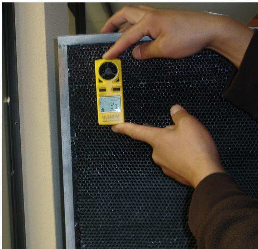
Figura 5.13 Velocidad alcanzada en la esquina superior izquierda del direccionador de flujo
