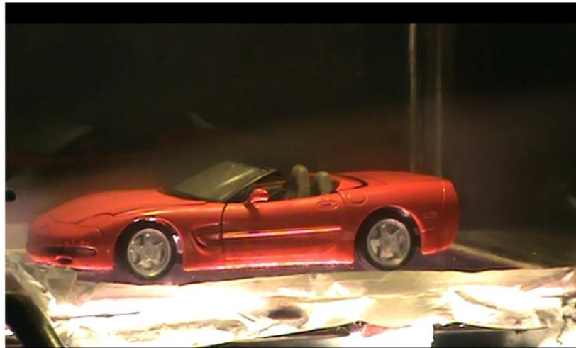
Figura 5.20 Vehículo a escala 1:18 sometido a pruebas de sustentación aerodinámica
