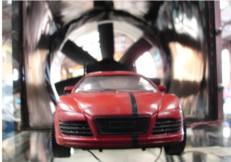
Figura 5.24 Vehículo a escala 1:18 sometido a pruebas de sustentación
