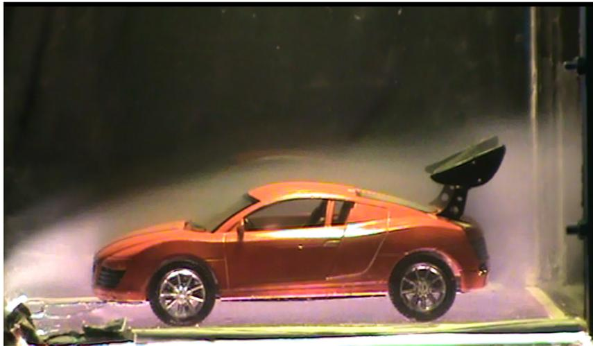
Figura 5.34 Vehículo con alerón sometido a prueba de capa límite
