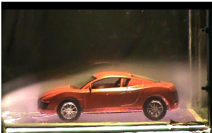
Figura 5.35 Vehículo sin alerón sometido a prueba de capa límite
