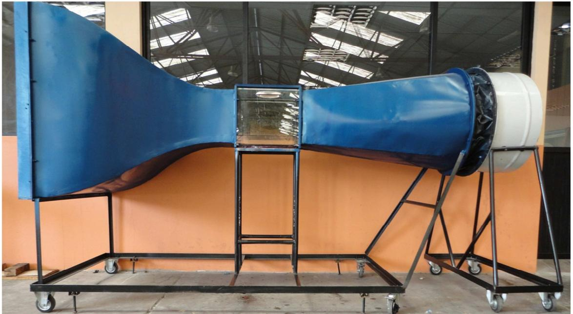
Figura 4.10 Túnel de viento
