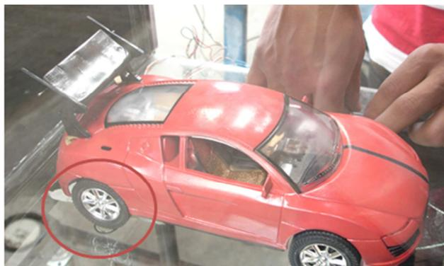
Figura 5.18 Calibración de sensores (ancho de vía y batalla)
