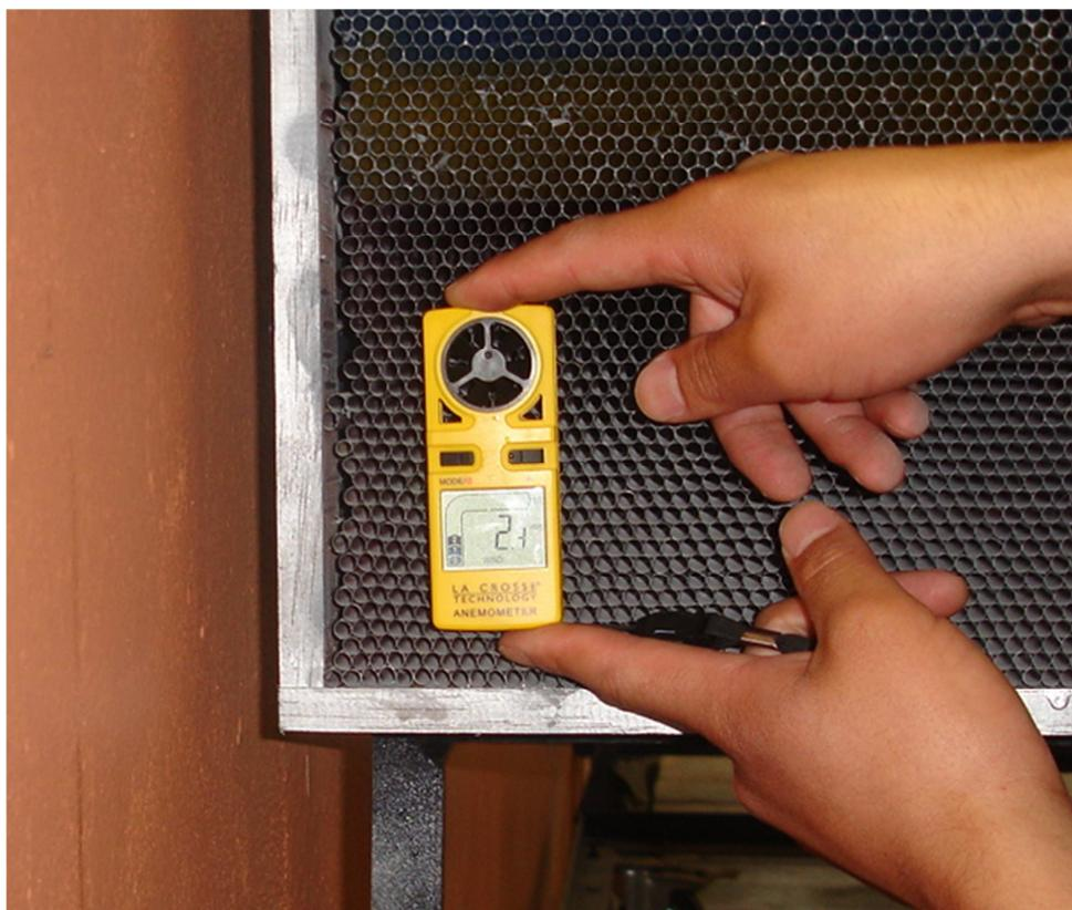
Figura 5.14 Velocidad alcanzada en la esquina inferior izquierda del direccionador de flujo
