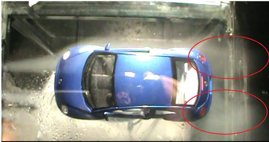
Figura 5.37 Vista superior de vehículo con la parte trasera inclinada
