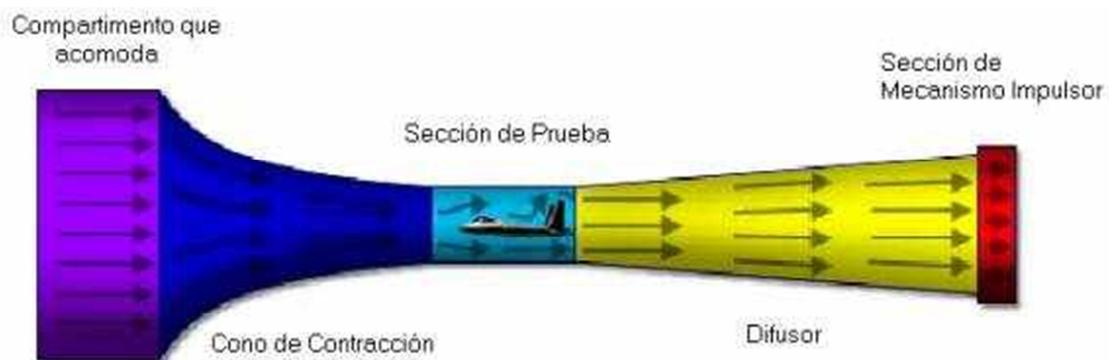
Figura 1.6 Esquema de un túnel de viento y sus componentes
