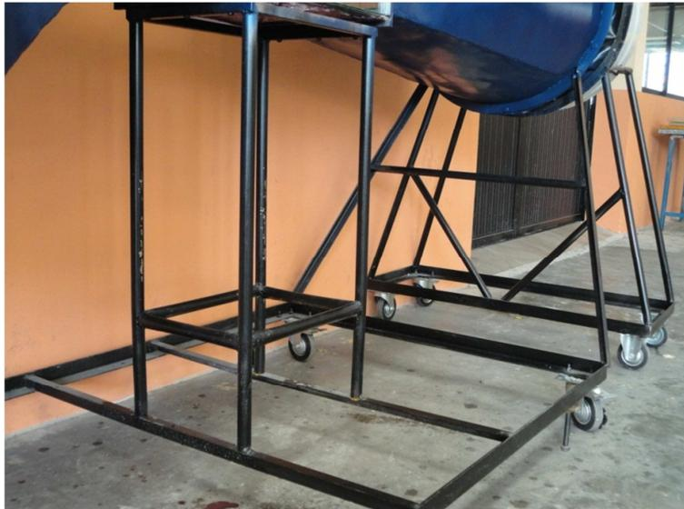
Figura 4.14 Estructura o base del túnel de viento
