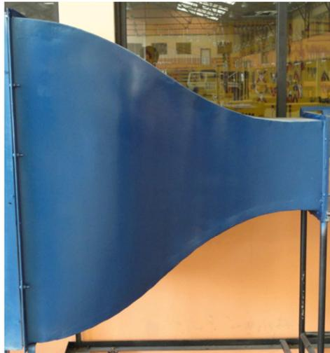
Figura 4.11 Sección de Contracción
