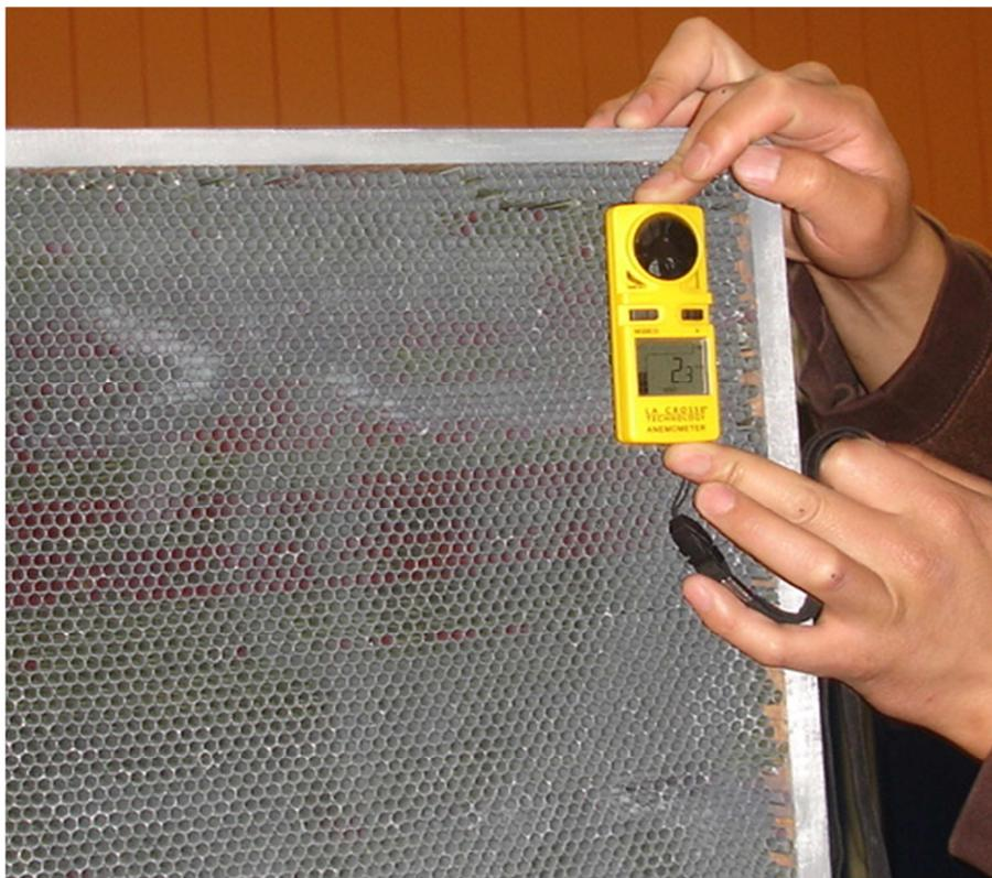
Figura 5.12 Velocidad alcanzada en la esquina superior derecha del direccionador de flujo
