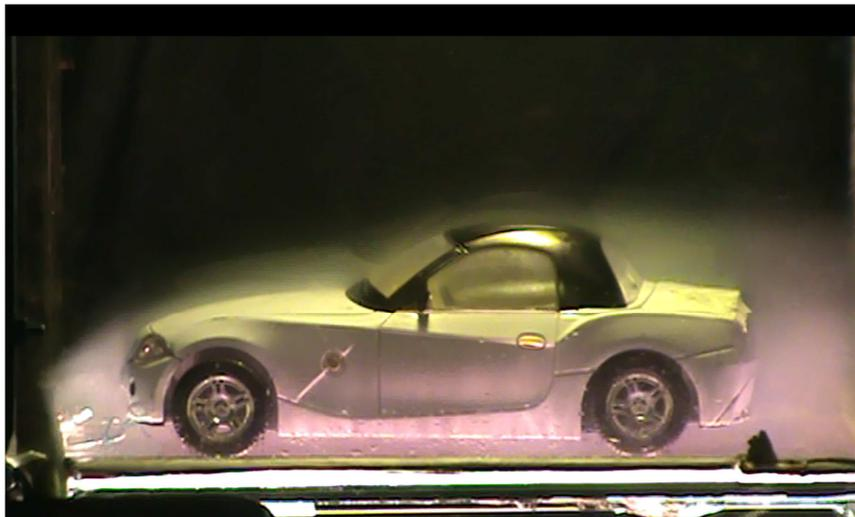
Figura 5.33 Vehículo sin alerón sometido a prueba de capa limite
