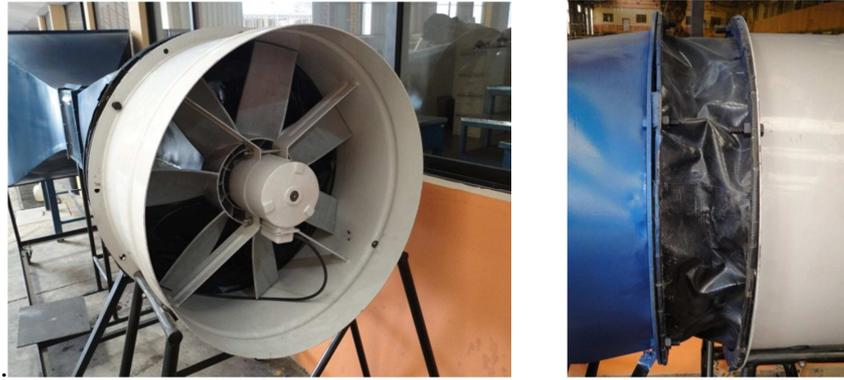
Figura 4.16 a) Montaje del ventilador    Figura 4.16 b) Manga acople del ventilador
