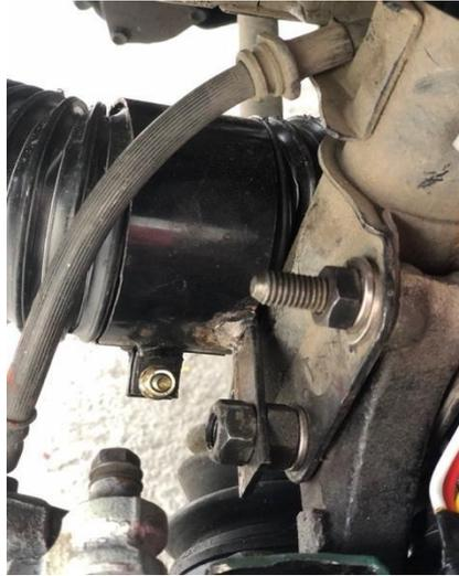
Figura 59 Soporte del ducto de ventilación con placa
