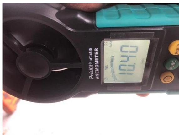
**ANEXO 10 Velocidad de aire en la salida de la campana. Conducto Derecho.**
