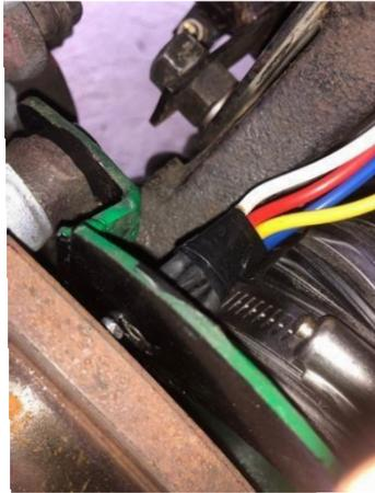
Figura 69 Adaptación del sensor infrarrojo y sensor hall en el vehículo
