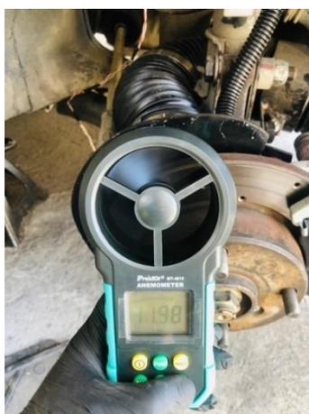
**ANEXO 7 Velocidad de aire en la salida de tubería rígida. Conducto Izquierdo.**
