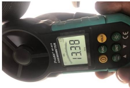
**ANEXO 8 Velocidad de aire en la salida de tubería rígida. Conducto Derecho.**
