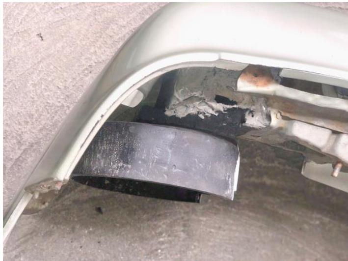
Figura 55 Instalación de la impresión 3D al guardachoque
