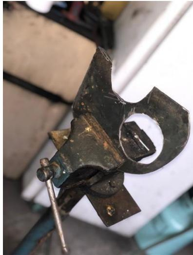
Figura 42 Construcción del plato de protección del disco de freno
