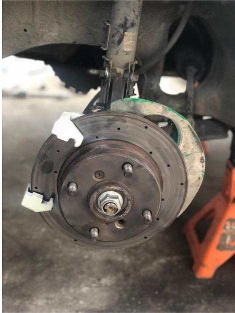
Figura 47 Instalación del palto protector al sistema.
