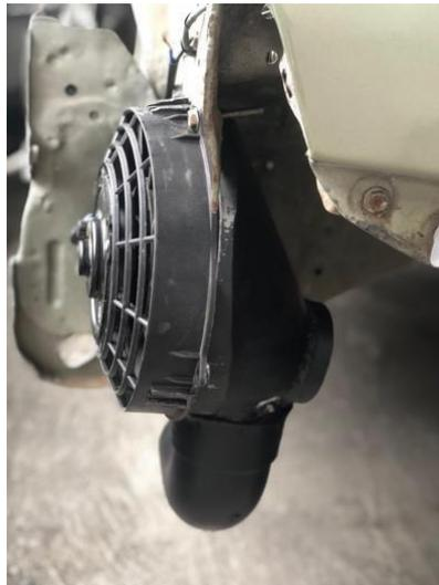
Figura 39 Ubicación del electroventilador
