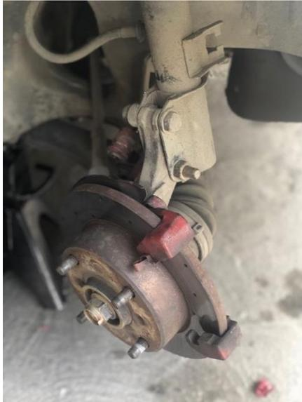
Figura 40 Extraer el plato de protección del disco de freno.
