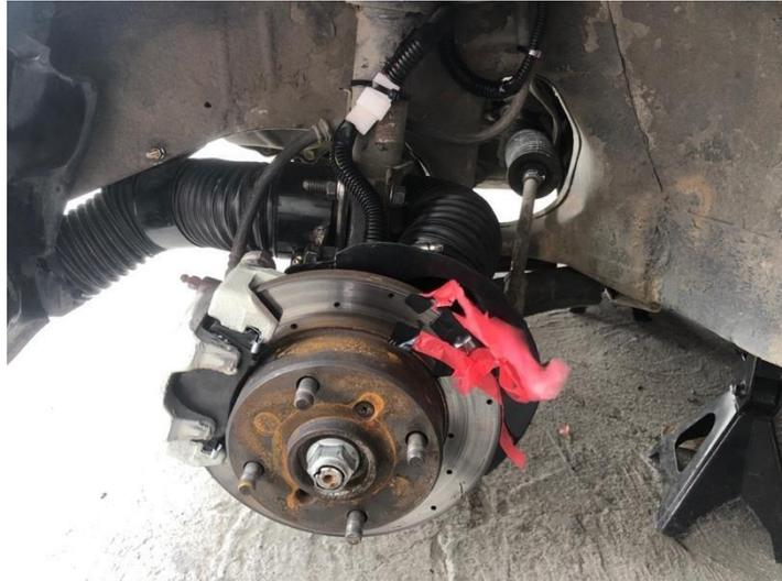
Figura 76 Ventilación en discos
