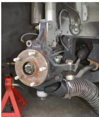
Figura 15 Conducto de ventilación.
