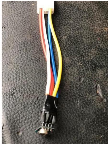
Figura 51 Socket de comunicación del sensor.
