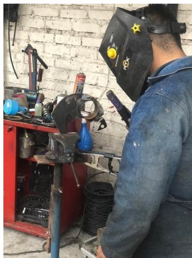
Figura 43 Soldadura del acople de la tubería de ventilación de plato de protección.
