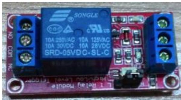
Figura 20 Módulo Relay.
