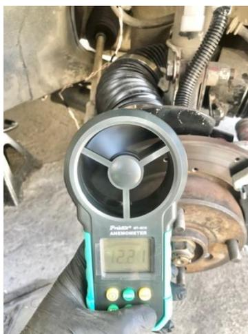
**ANEXO 6 Velocidad de aire en la entrada del plato de disco. Conducto Derecho.**
