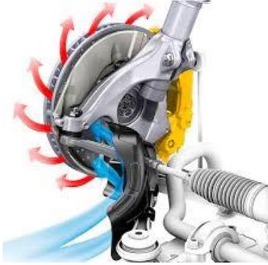
Figura 14 Ventilación dinámica de disco de frenos
