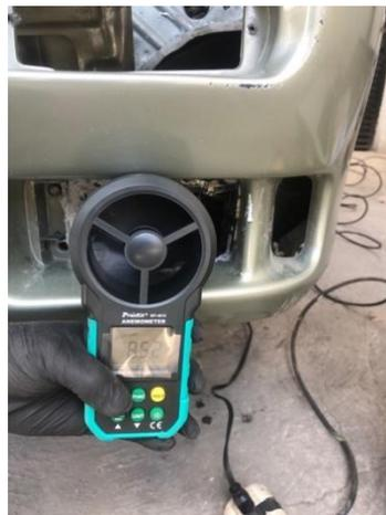
**ANEXO 3 Velocidad de aire en la salida de tubería rígida. Conducto izquierdo.**
