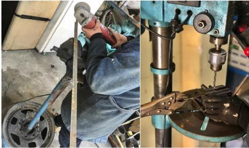
Figura 58 Fabricado de soporte de abrazadera
