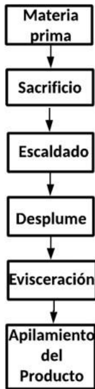
Figura 1: Diagrama de bloques del proceso de la planta. Fuente: (Autores)
