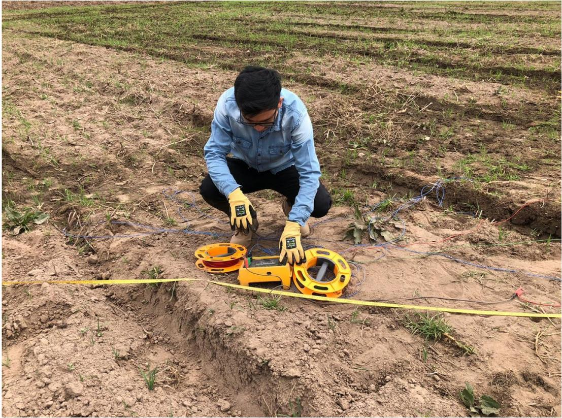
**Anexo 24: Instalación de las picas para realizar la medición de la resistividad del terreno.**
