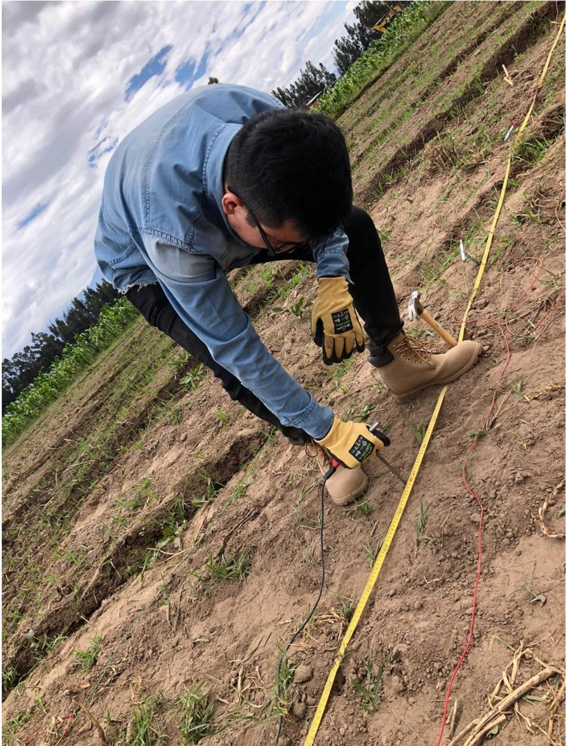
Anexo 25: Ejemplo de la medición de la resistividad del terreno a una distancia de 12 metros en el sentido de noreste a suroeste.
