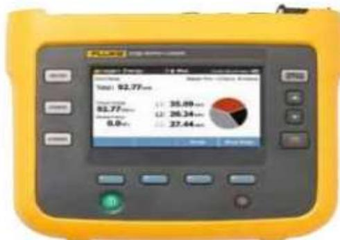
**FIGURA 33: ANALIZADOR DE REDES FLUKE 1730**
