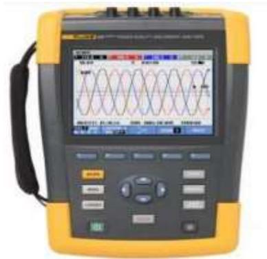
**FIGURA 31: ANALIZADORES TRIFÁSICOS DE CALIDAD ELÉCTRICA**
