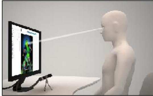
Figura 16. Seguimiento ocular del usuario mediante el sensor Eye Tracker Fuente: Eye Tracker [13]
