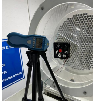
Figura 22. Implementación del medidor de RPM para toma de datos. Fuente: [Autor].
