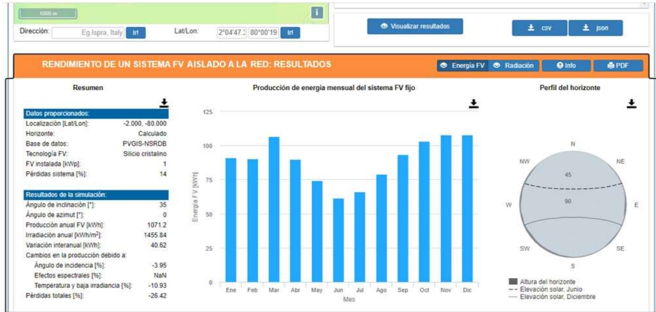
Figura 15. Rendimiento de un sistema FV aislado a la red en la comuna "Masa 2"
