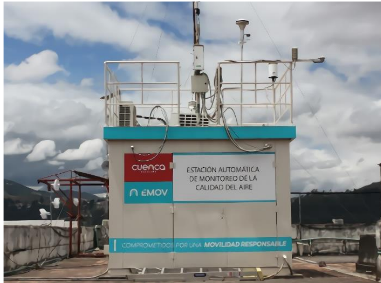
Figura 4. Estación automática de calidad del aire y meteorología localizada en la estación MUN. Fuente: (EMOV, 2019)
