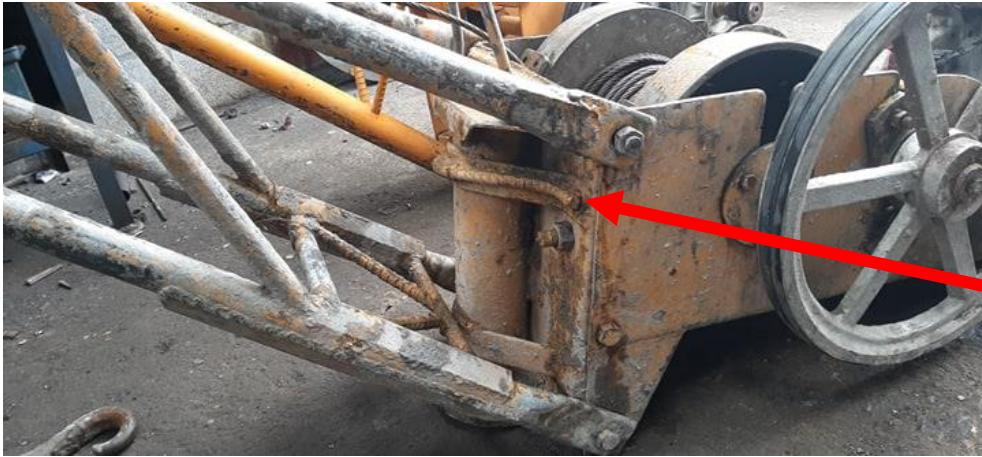
Figura 148 Refuerzo del tubo que una la carcasa con la base. Fuente: Autores.
