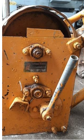
Figura 28 Mal dimensionado y falta de sistema de freno automático. Fuente: Autores.
