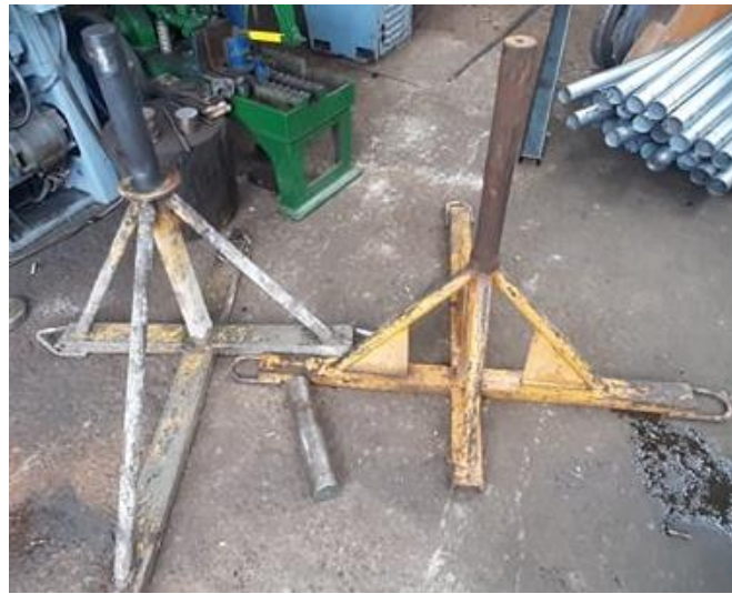
Figura 29 Base mal dimensionada y demasiado pesada. Fuente: Autores,
