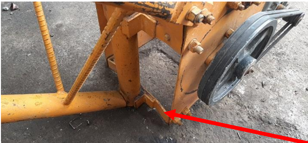
Figura 149 Deformación en el tubo que uno la carcasa con la base. Fuente: Autores.
