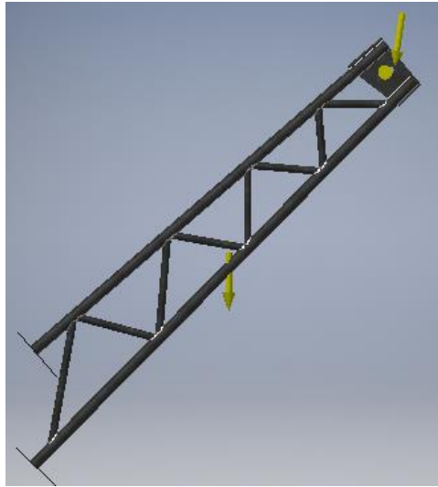
Figura 48 Representación de cargas en la celosía. Fuente: Autores.
