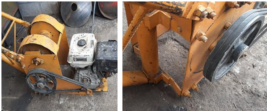
Figura 27 Deficiencia de diseño en la carcasa parte superior. Fuente: Autores.
