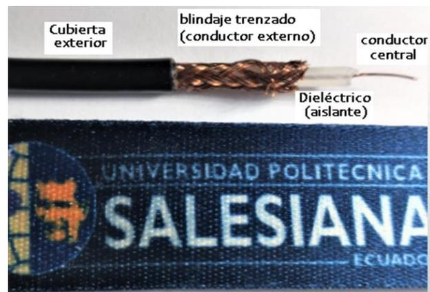
Figura 1. Vista interna de un cable coaxial.
