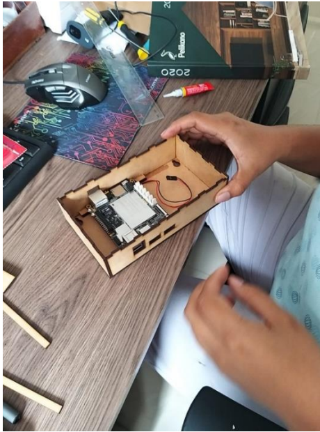
Figura A.21. Armado del case, soporte para el LattePanda.
