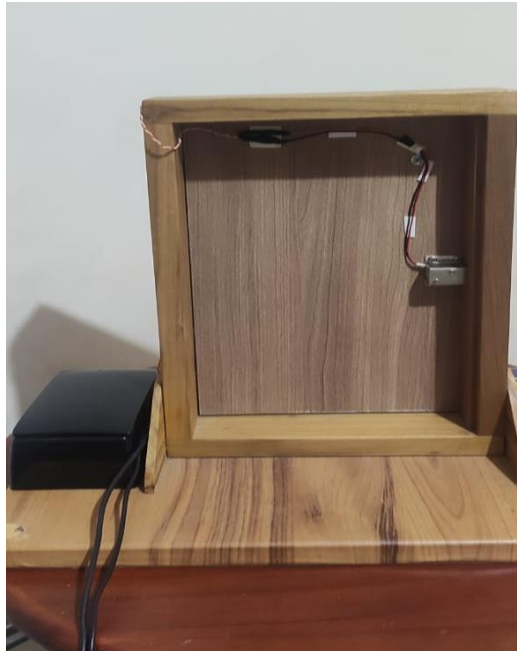
Figura 58. Puerta con cerradura eléctrica y módulo esp32 wifi Arduino para simulación de acceso mediante reconocimiento facial
