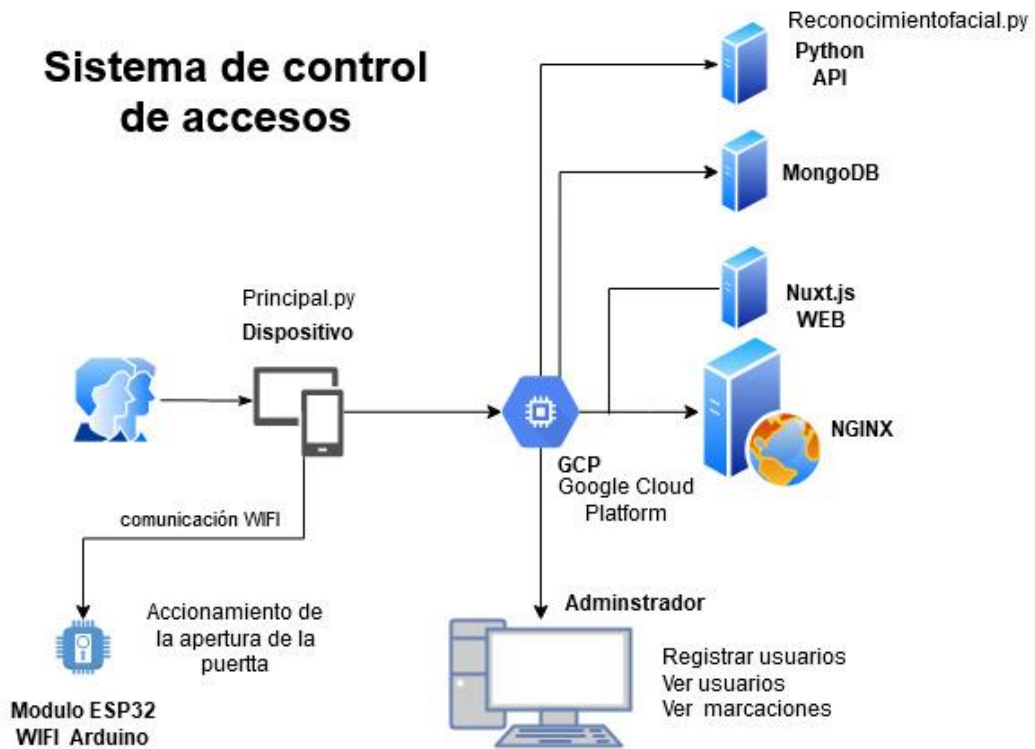
Figura 16. Diseño del sistema de control de acceso.
