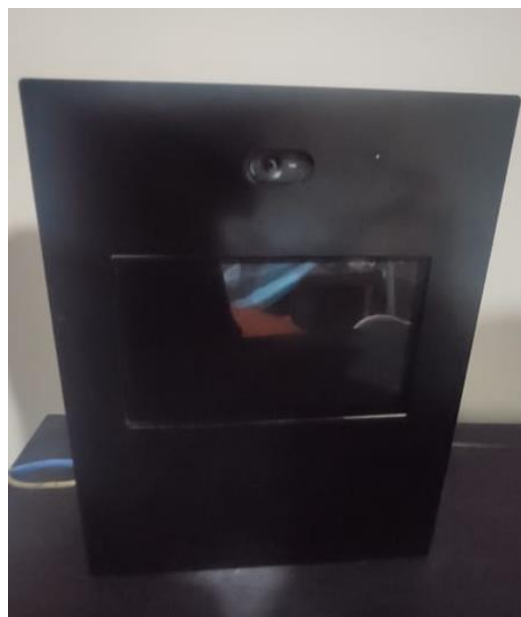
Figura 59. Estructura del prototipo para control de acceso.
