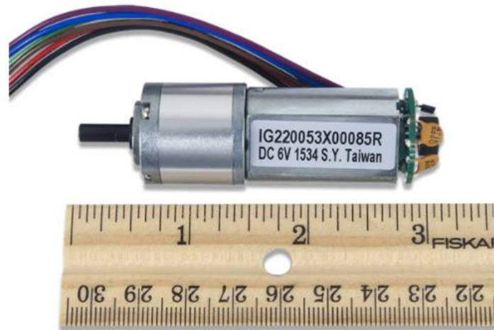
Figura 15: Motor de corriente continua (Digilent, 2018)
