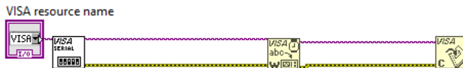
Figura 238. Puerto serial con herramienta visa, practica 8.
