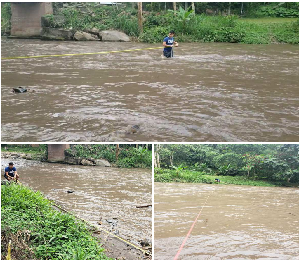
Ilustración 7: Medición de una sección transversal en el Río Tutanangoza
