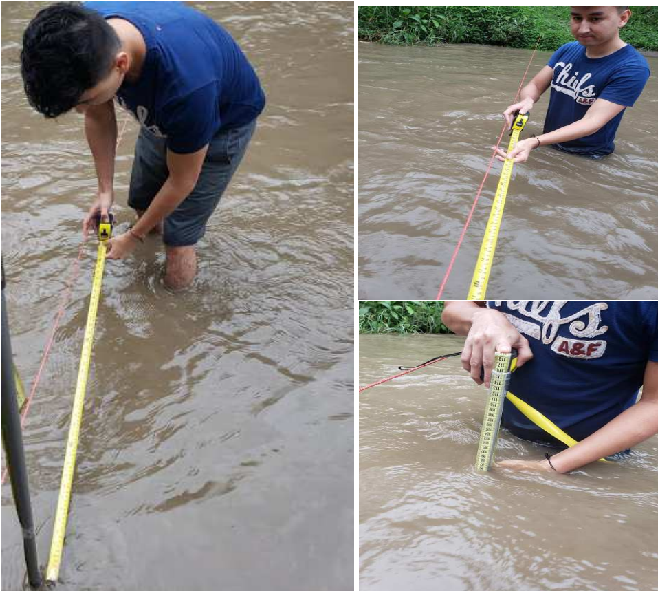
Ilustración 8: Profundidad del Río Tutanangoza en una sección transversal cada metro
