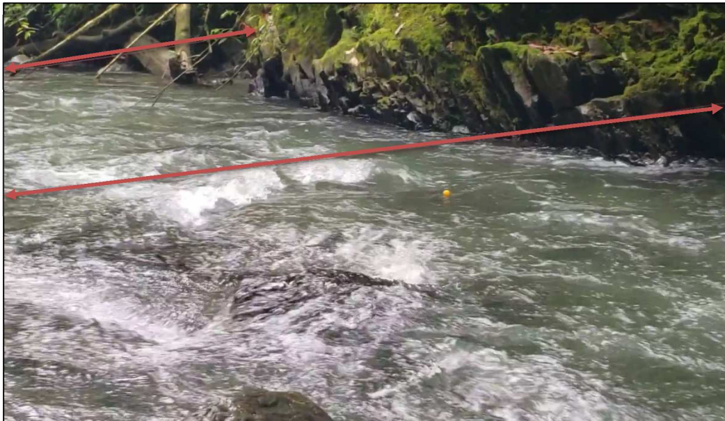
Ilustración 6: Velocidad del flotador en el transcurso de dos secciones transversales
