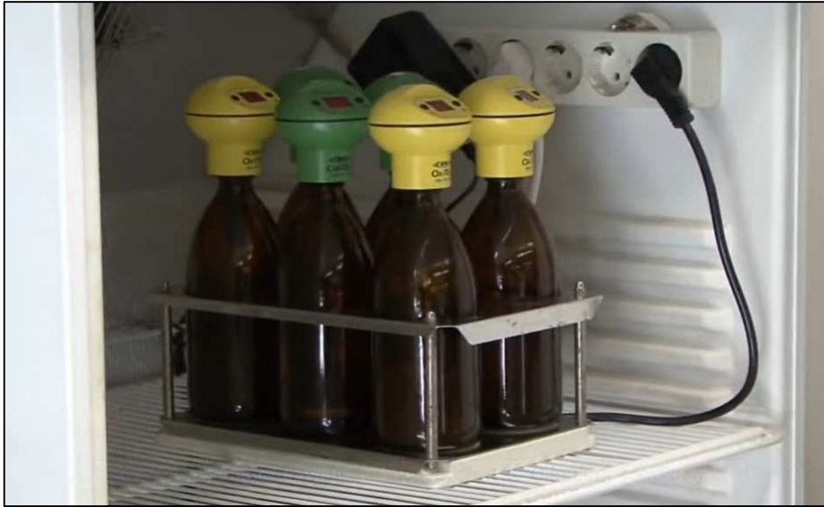
Ilustración 15: DBO metro para determinar la Demanda Bioquímica de Oxígeno (DBO 5 ) Fuente: Autor
