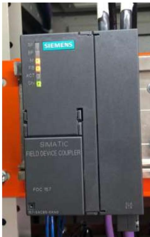
**Ilustración 16.** Acoplador Profibus DP/PA
