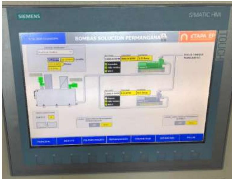
**Ilustración 18.** Pantalla HMI SIMATIC KTP1200 Basic pn del tablero de control TC-Do.
