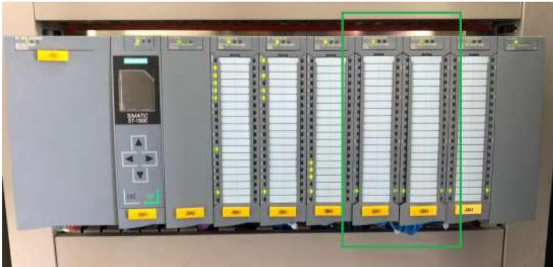
**Ilustración 15.** Módulo de salidas digitales conectado al PLC del tablero TC-
