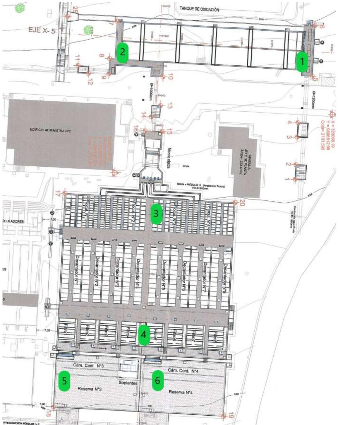
**Ilustración 71.** Puntos de muestro para medición de manganeso
