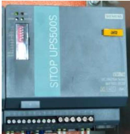
**Ilustración 35.** SITOP UPS500S EQUIPO BASICO 5 KWS 6EP1933-2EC51
