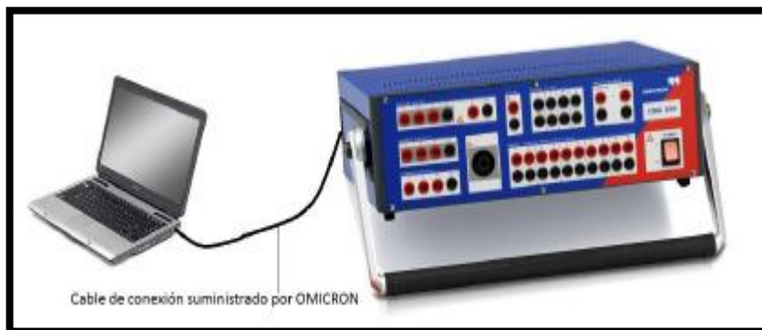
FIGURA 65: IMAGEN REFERENCIAL DE CONEXIÓN ENTRE PC Y OMICRON.
