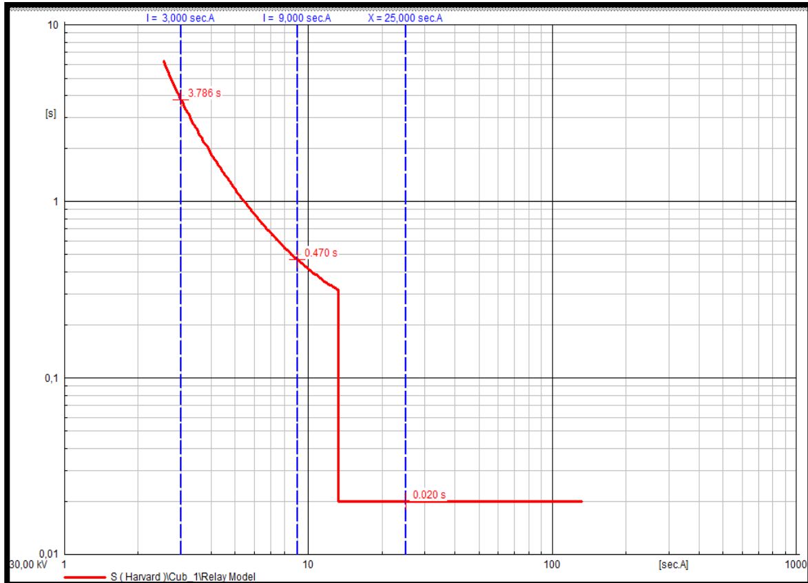
FIGURA 212: GRAFICA DE LAS CURVA DE OPERACIÓN DEL RELÉ S CON SU PUNTOS DE PRUEBA Y TIEMPOS DE DISPARO EN EL PROGRAMA DIGSILENT.
