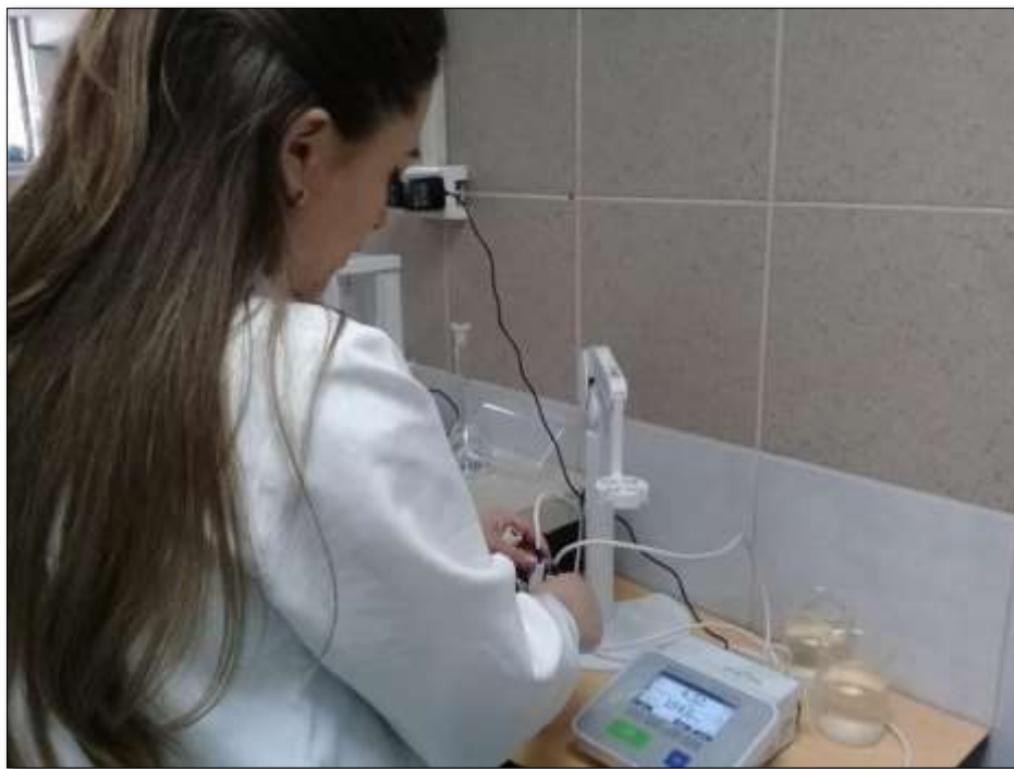
Figura 9 Toma de pH con ayuda de un potenciómetro.
