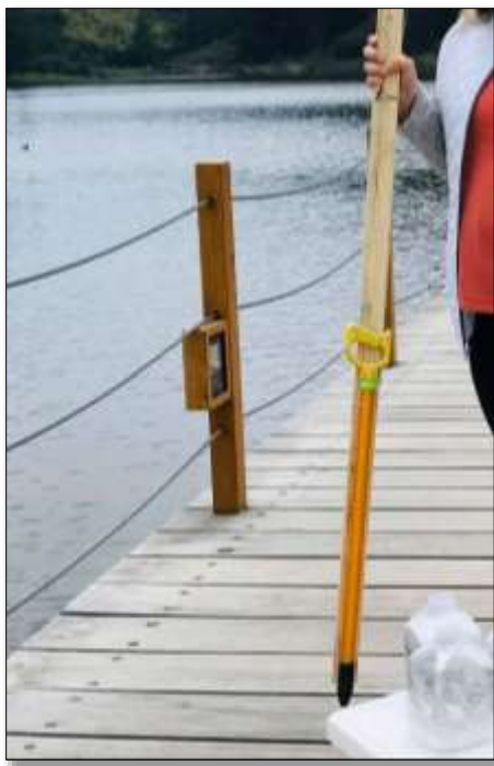
Figura 4 Instrumento diseñado para la recolección de muestras de agua a distintas profundidades.
