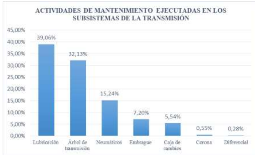
Figura 25. Mantenimientos ejecutados en los subsistemas de la transmisión.
