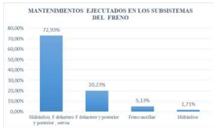
Figura 27. Mantenimientos ejecutados en los subsistemas de freno.
