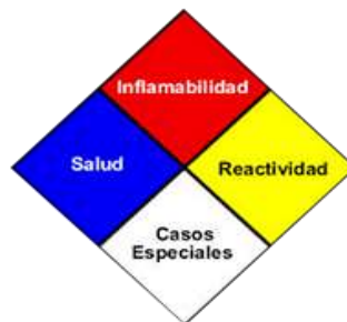
Figura 101. Rombo de seguridad NFPA
