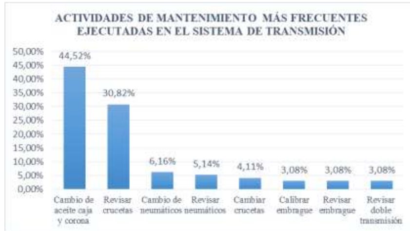
Figura 26. Actividades de mantenimiento más frecuentes ejecutadas en el sistema de transmisión.
