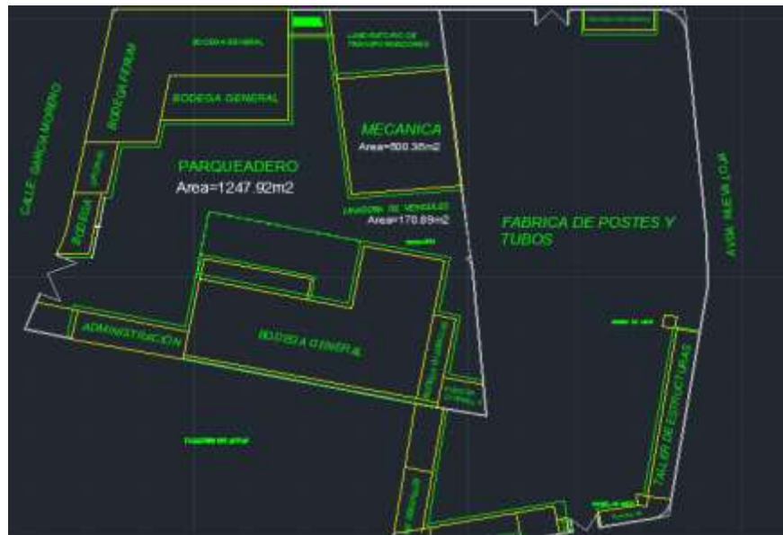
Figura 20. Plano de área de bodegas, talleres de mantenimiento y aparcamiento vehicular.
