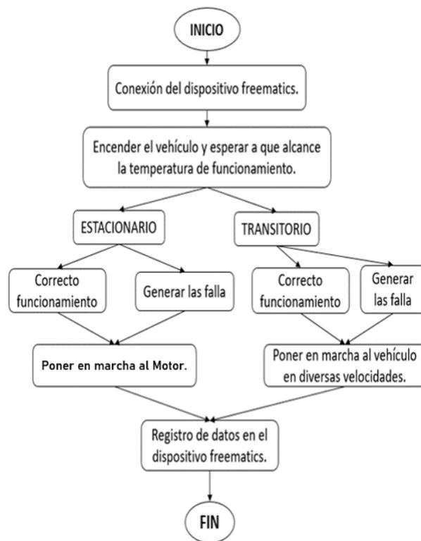
**Figura 3** Proceso para la adquisición de datos.
