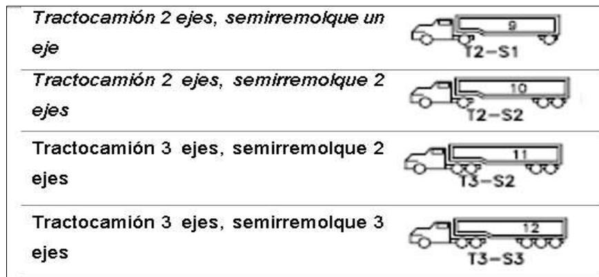
Figura 19: Semirremolques. Fuente [4]
