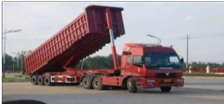
*Figura 31: Semirremolque descarga posterior. Fuente: Autor*
