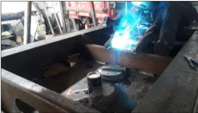
*Figura 82: Suelda Mediante Proceso Mig. Fuente Autor*
