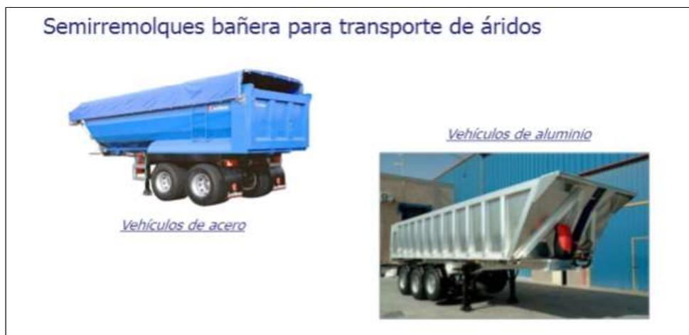
Figura 1 Semirremolque bañera para transporte de áridos. Fuente: [3]
