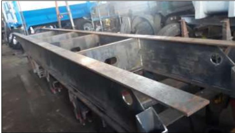
*Figura 78: Construcción de Chasis en Talleres AVIMEC. Fuente: Autor*
