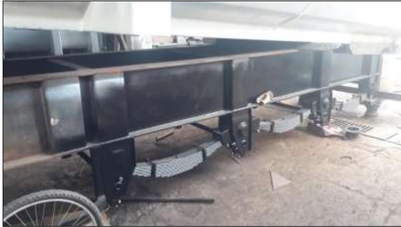
*Figura 81: Montaje De Suspensión En Talleres Avimec. Fuente: Autor*
