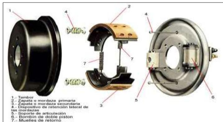
Figura 37: Sistema de Frenos. Fuente: [5]
