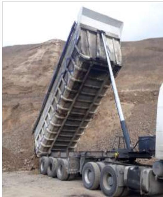
*Figura 88: Semiremolque descargando material pétreo. Fuente Autor*
