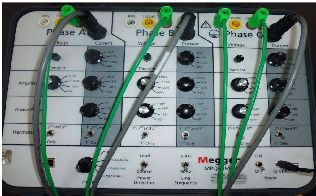
Figura 30. MPQ-SIM-01 ajustes valores iniciales [autores]
