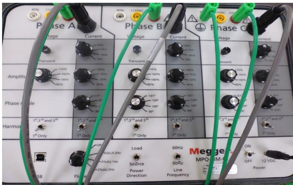
Figura 31. MPQ-SIM-01 ajustes ángulo selector intensidad  $-30^\circ$  para cada fase [autores]
