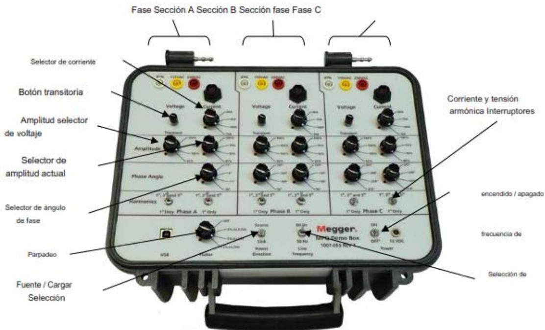
Figura 12. Funciones de conmutación y control simulador MPQ-SIM-01 [9]
