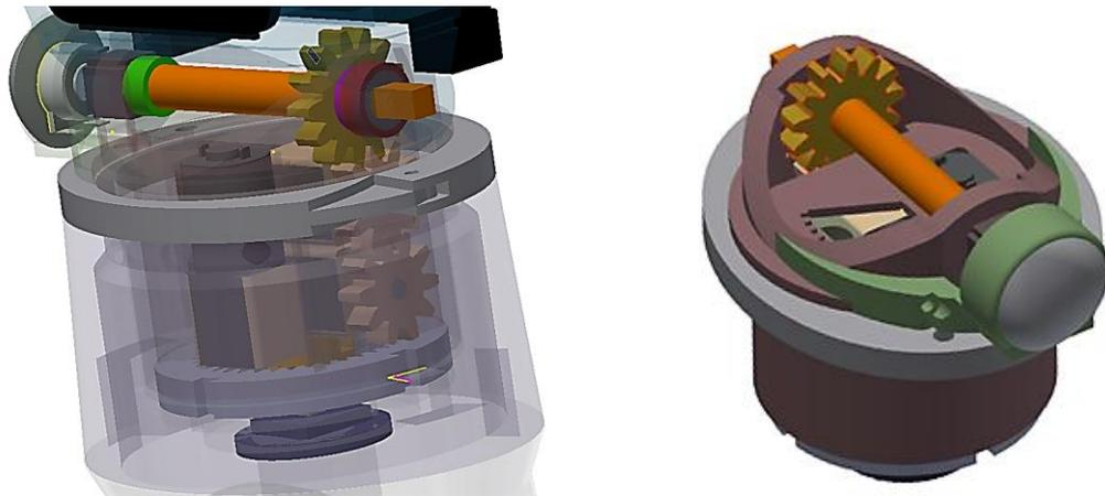
Figura 35. Ensamble del sistema del movimiento de flexión-extensión.
