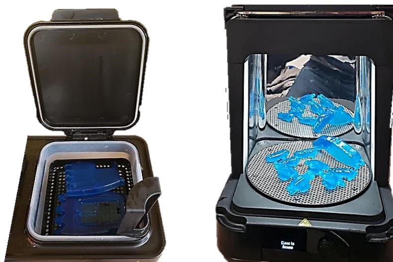
Figura 40. a) Kit para el lavado. b) Kit para el curado (Form Cure).
