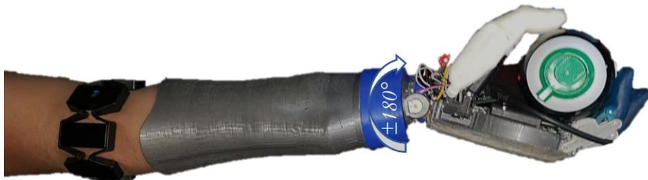
Figura 89. Movimiento de pronación-supinación del sistema de muñeca
