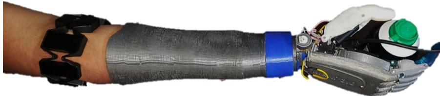
Figura 83. Movimiento de agarre cilíndrico (botella).
