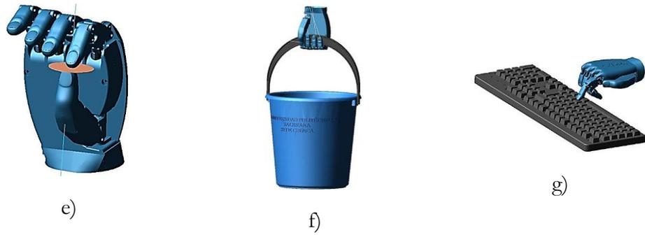
Figura 13. a) Flexión y extensión, b) Agarre lateral, c) Agarre cilíndrico (botella), d) Agarre cilíndrico (marcador), e) Agarre de precisión, f) Agarre tipo gancho, g) Posición de teclado [33].
